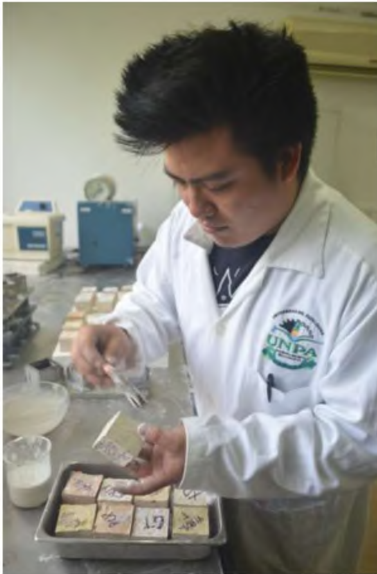
Figura 52: Recubrimiento de membrana de curado 52
