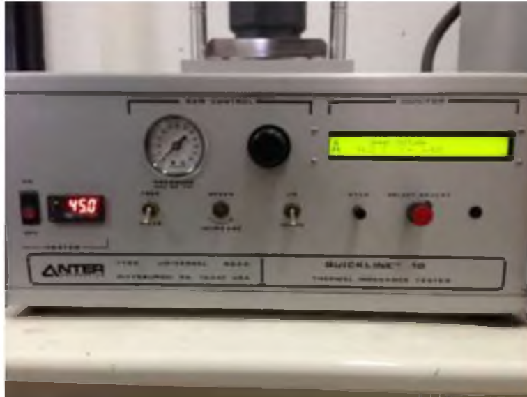
Figura 59: Prueba de Conductividad Térmica 59
