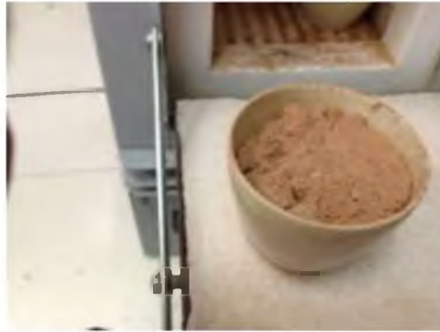
Figura 25: Ceniza de Caña tratada a 900° C 25
