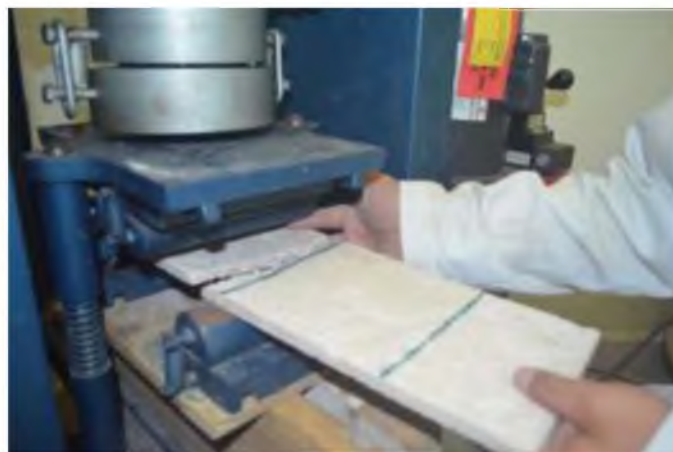
Figura 57: Ruptura a Flexión de la Viga 57
