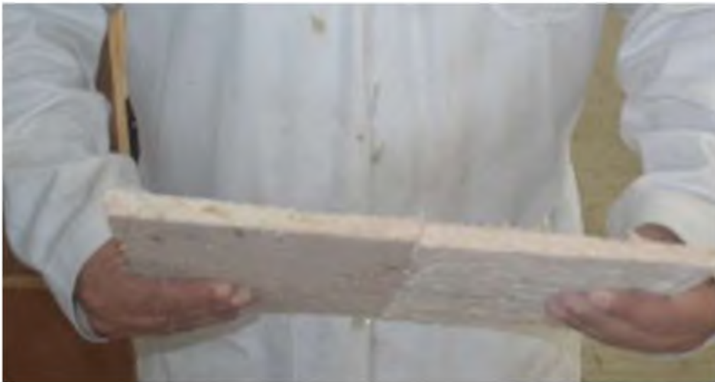
Figura 70: Usabilidad al corte con sierra 70
