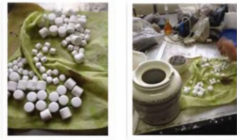
Figura 19: Jarra de porcelana y medios de molienda de alúmina 19
