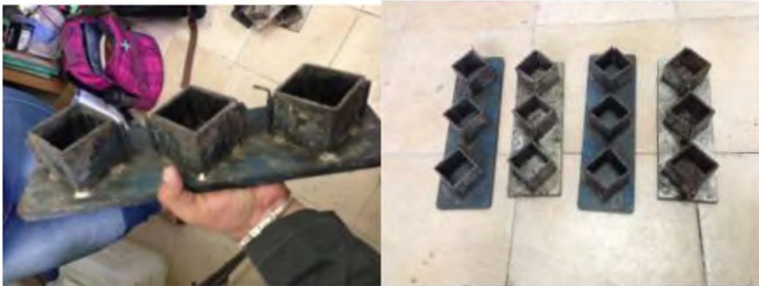
Figura 26: Limpieza de moldes 26
