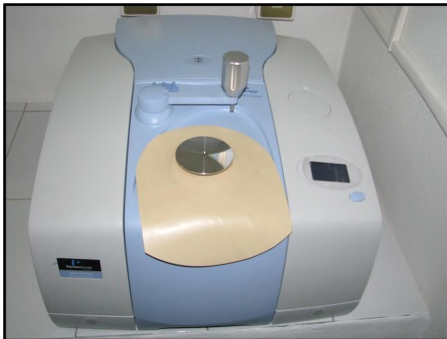
Figura 7.7 Espectrofotómetro de infrarrojo con transformada de Fourier DYNASCAN. ESPECTRUM 100. PERKIN ELMER.
