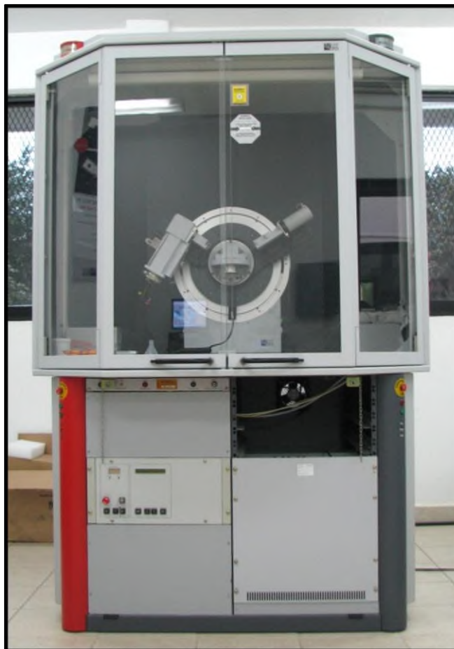
Figura 7.4. Equipo de Difracción de Rayos X D8 Advance BRUKER.
