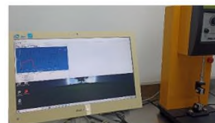
Figura 14. Pruebas mecánicas realizadas en el Centro de Investigaciones Científicas (CIC) de la Universidad del Papaloapan. A) Resistencia a la tracción, B) Obtención de datos para calcular el Módulo de Young.
