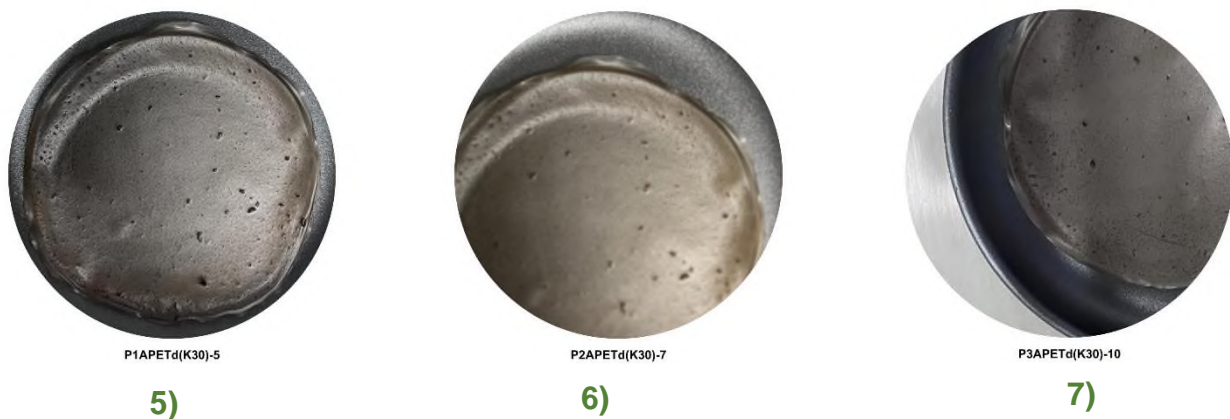
Figura 13. Películas de almidón modificado con los productos de PET degradado con arcilla montmorillonita K30.
