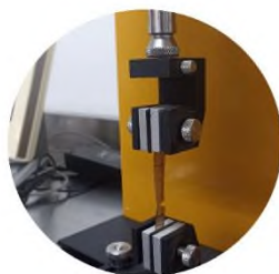
Figura 14. Pruebas mecánicas realizadas en el Centro de Investigaciones Científicas (CIC) de la Universidad del Papaloapan. A) Resistencia a la tracción, B) Obtención de datos para calcular el Módulo de Young.
