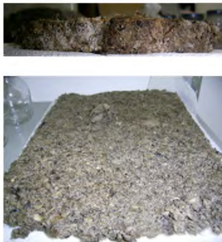
Figura 4.15. Fibra triturada solo antes del secado, con resina natural (brea) y polivinílica.
