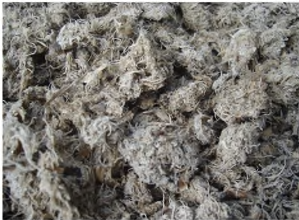
Figura 4.9. Cáscara de piña sometida a un proceso de convección natural por un intervalo de 3 semanas
