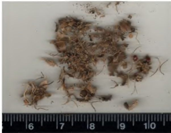
Figura 4.11. Determinación de tamaño de fibras de cáscara de piña
