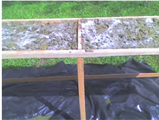
Figura 4.6. Secado de las fibras procedentes de la cáscara de piña
