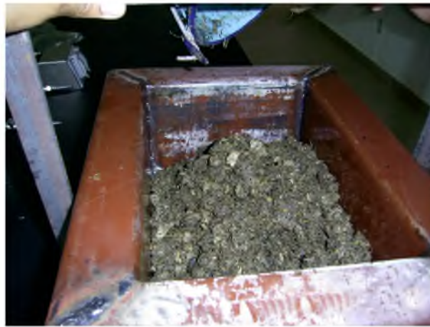
Figura 4.13. Colocación de fibra de cáscara de piña en molde de acero al carbono
