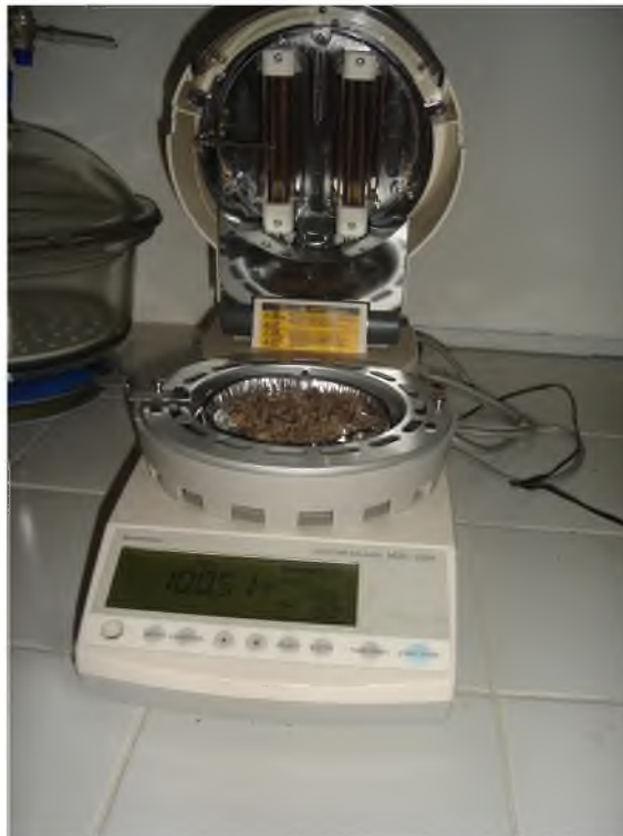
Figura 4.12. Determinación de humedad relativa de las muestras de cáscara deshidratada.
