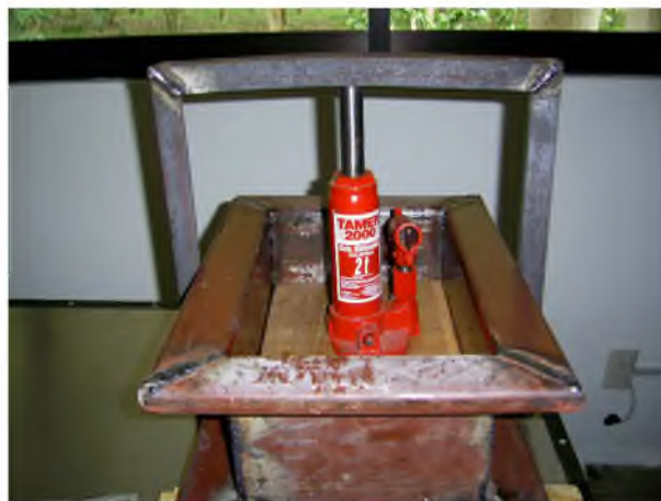
Figura 4.14. Prensado de tableros aglomerados de cáscara de piña
