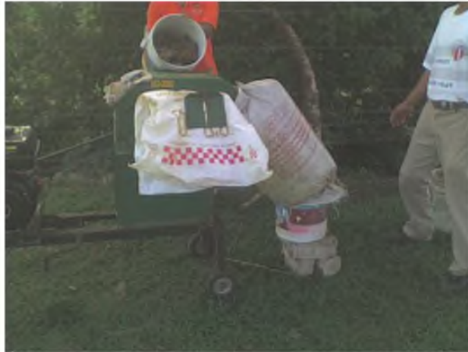
Figura 4.4. Alimentación de fibra de piña en la desintegradora de forraje
