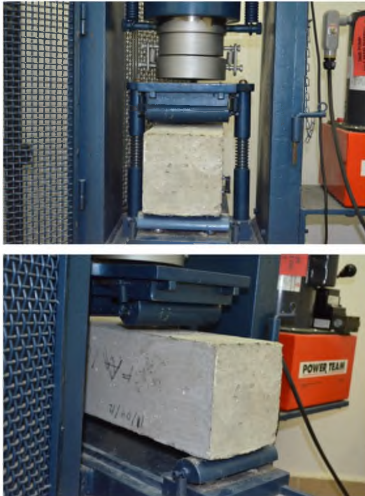
Figura 39. Prueba de Flexión a la Viga en Prensa Hidráulica.
