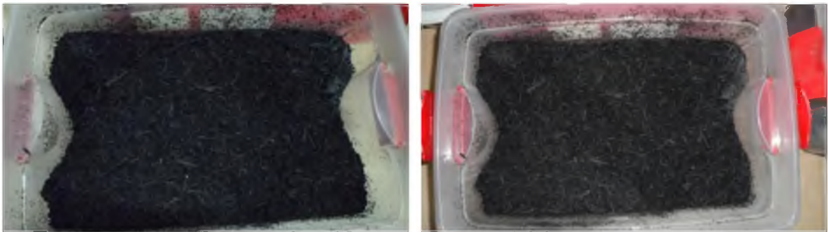
Figura 7. Caucho elaborado con 2 reactivos diferente. A la derecha se presenta la proporción con Metanol y a la derecha con Acetona.
