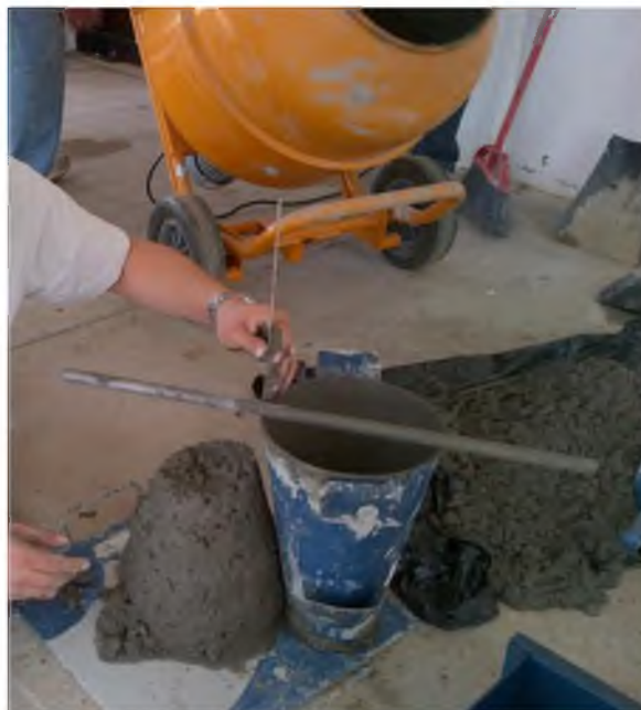
Figura 29. Medición del Revenimiento en la mezcla.
