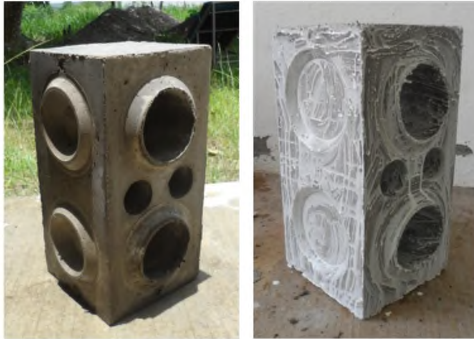
Figura 28. Bloque Concreto-caucho con membrana.
