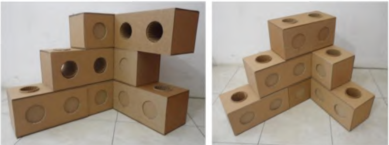
Figura 13. Fotografía del prototipo representando un muro sólido y muro intercalando bloques sólidos y bloques perforados.
