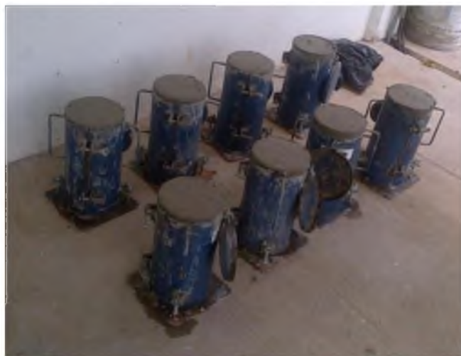
Figura 30. Resultado final de la elaboración de especímenes de concreto-caucho.
