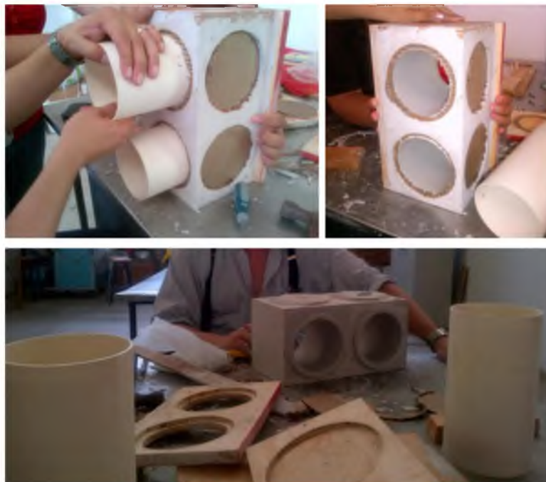
Figura 15. Descimbrado y resanado del prototipo de yeso obtenido.
