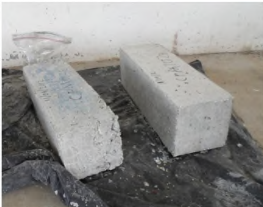
Figura 38. Curado de las Vigas.
