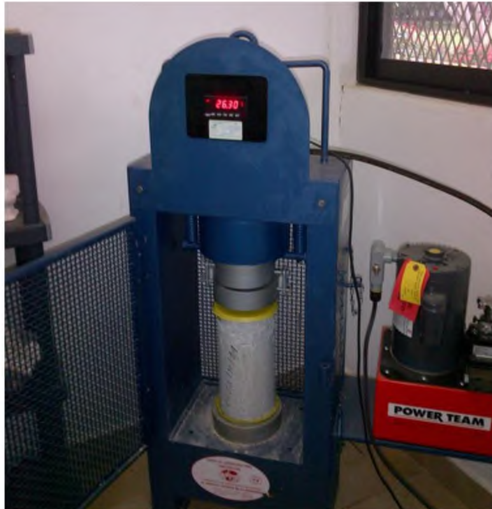
Figura 33. Prueba de Compresión al Cilindro en Prensa Hidráulica.
