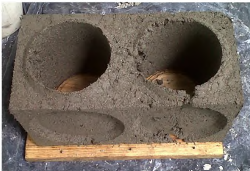
Figura 21. Tercer bloque de prueba elaborado de Concreto-Caucho aun en estado húmedo.
