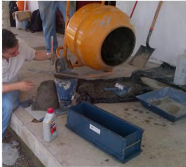
Figura 35. Medición del Revenimiento y preparación del molde para el vaciado.
