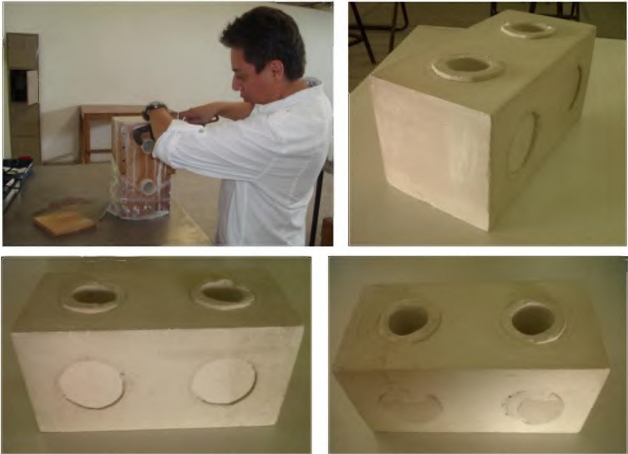
Figura 9. Fabricación en yeso de la primera propuesta de diseño para el bloque.
