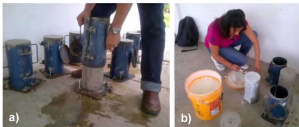
Figura 31. Proceso final de la elaboración de cilindros. a) Desmolde de los cilindros, b) Curado de las piezas.
