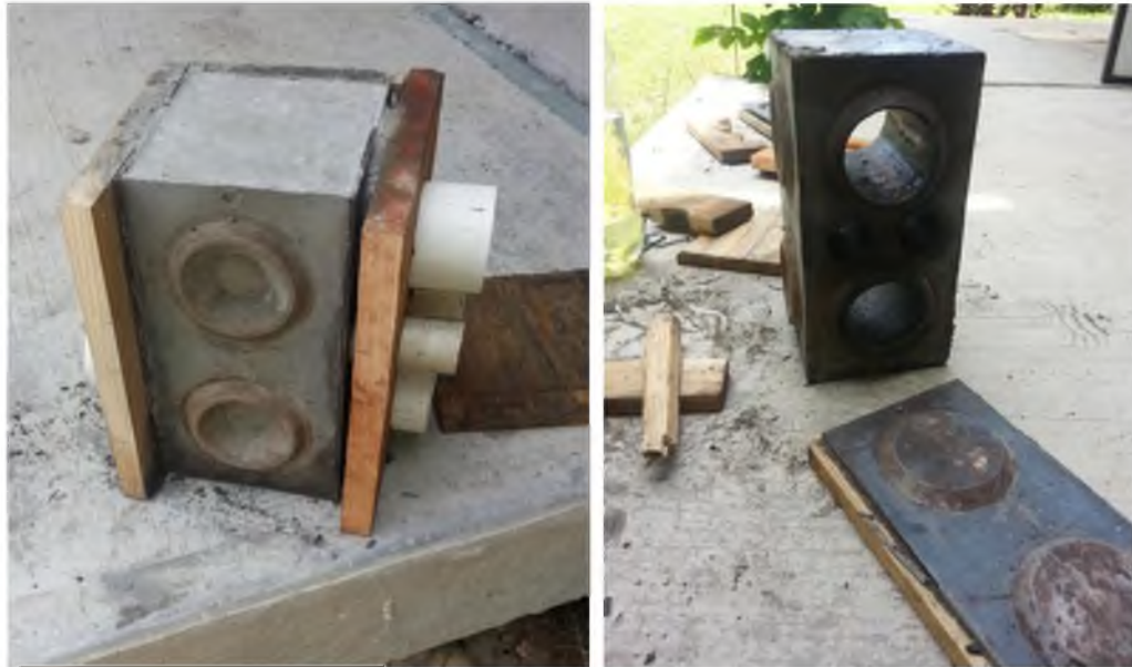
Figura 26. Descimbrado del Bloque de Concreto-Caucho.
