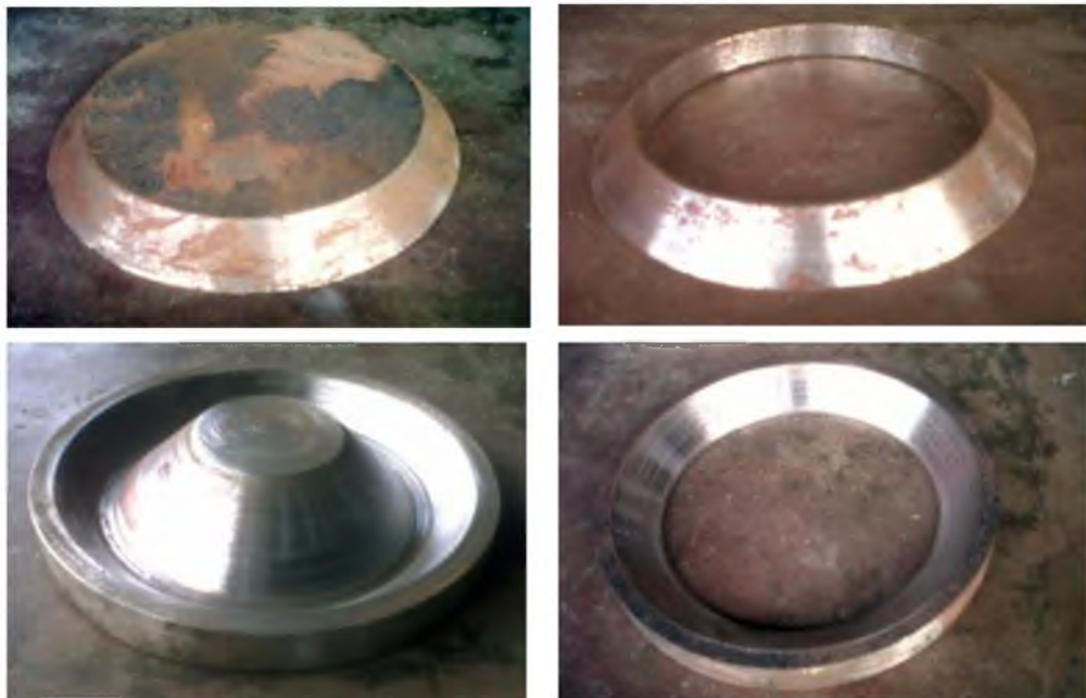
Figura 42. Resultado de las piezas en acero fabricadas en el torno.
