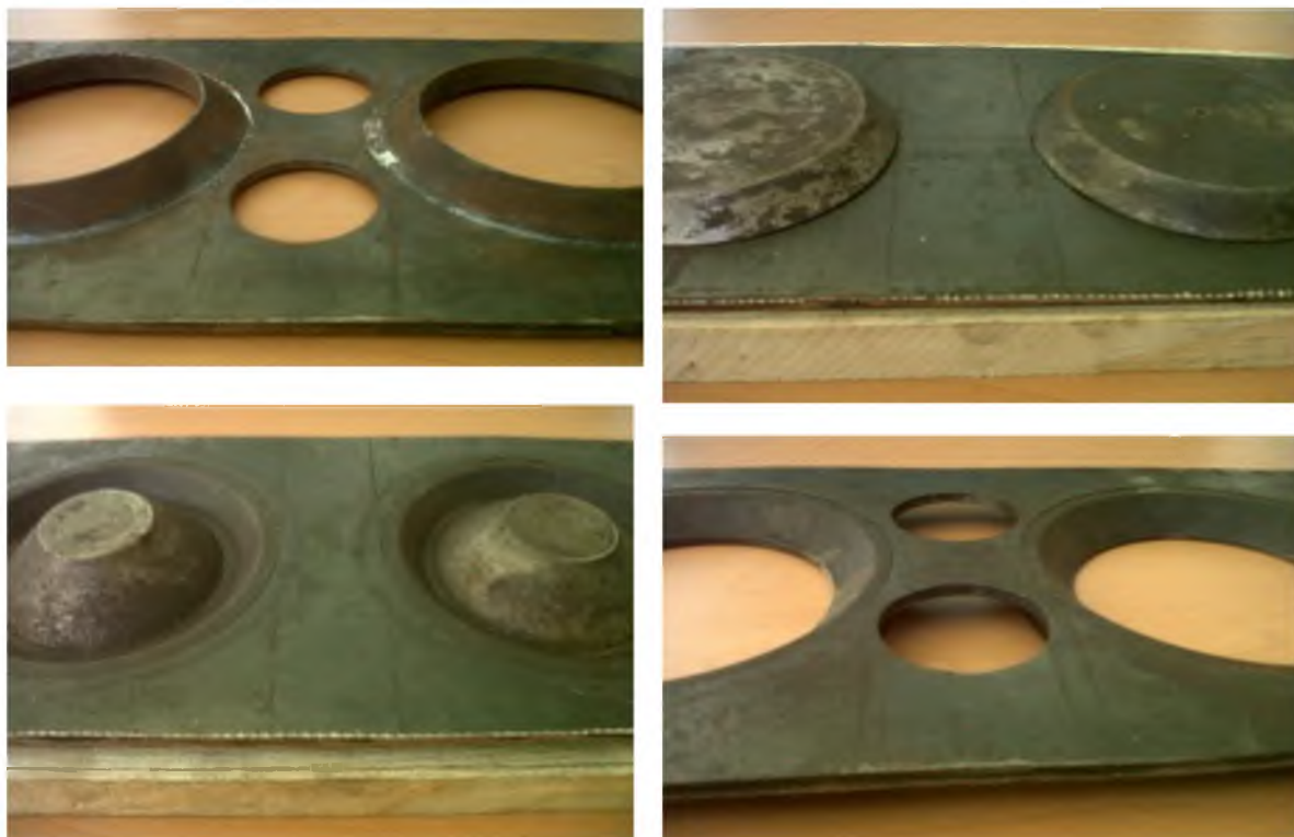
Figura 43. Detalle de la unión de las placas de acero y las piezas cónicas.
