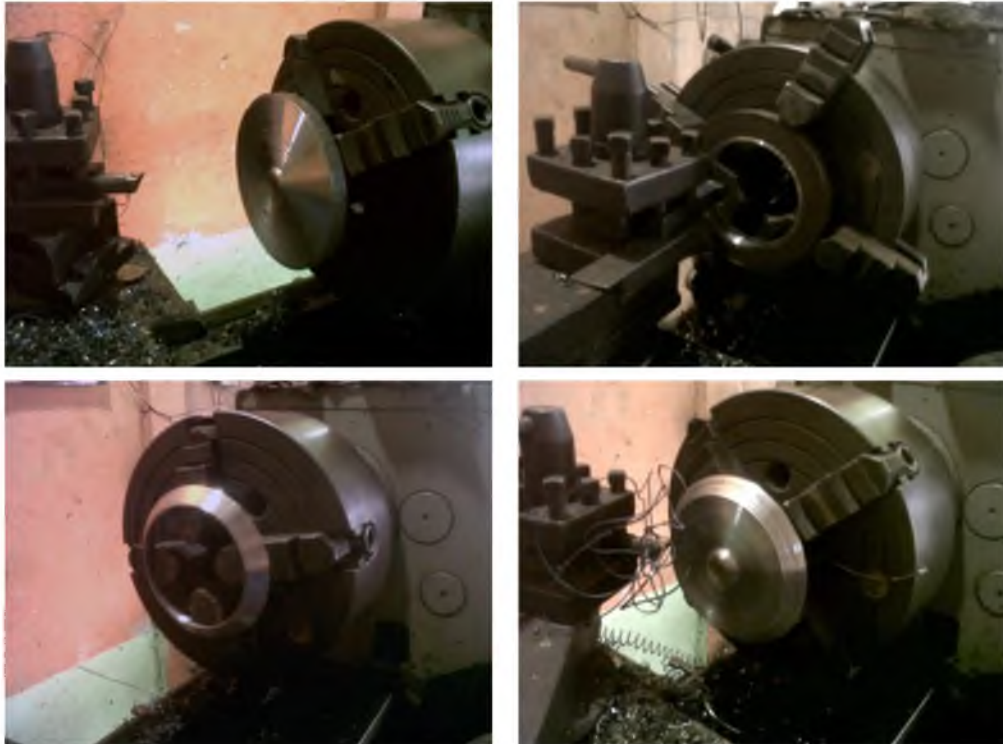
Figura 41. Proceso de manufactura de los conos truncados que se ocuparon en las placas de acero.
