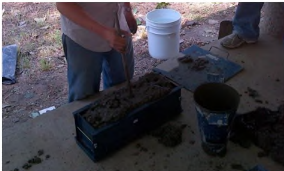
Figura 36. Vaciado del Concreto al Molde.
