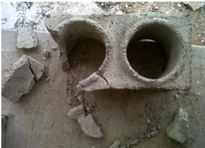
Figura 19. Segundo bloque de prueba elaborado con Concreto-Caucho.
