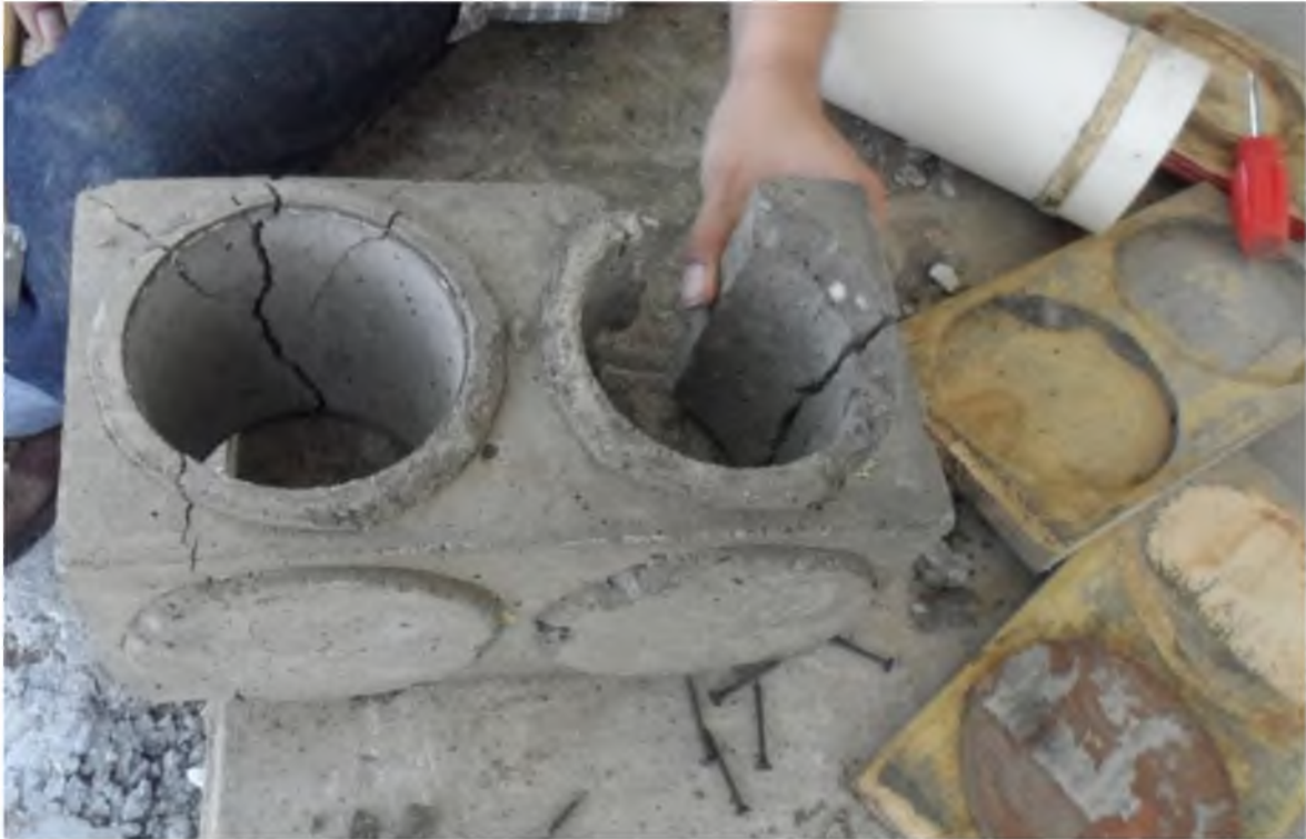
Figura 18. Primer bloque de prueba elaborado con Concreto-Caucho.
