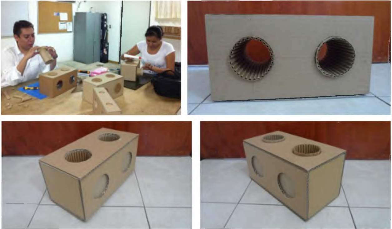
Figura 12. Proceso de fabricación y vistas del prototipo de cartón corrugado obtenida.
