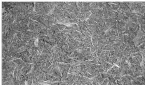
Figura 6. Caucho molido con molino industrial.
