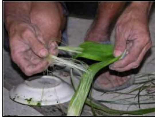
Figura 3.5. Extracción manual de la fibra mediante raspado.
