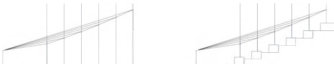
Figura 4.18: Vista lateral de las filas de gradas
