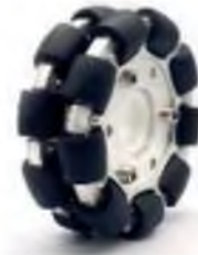
Figura 2.7 Rueda omnidireccional a 90°
