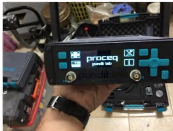
Fig. 9 Equipo para realización de prueba de ultrasonido.
