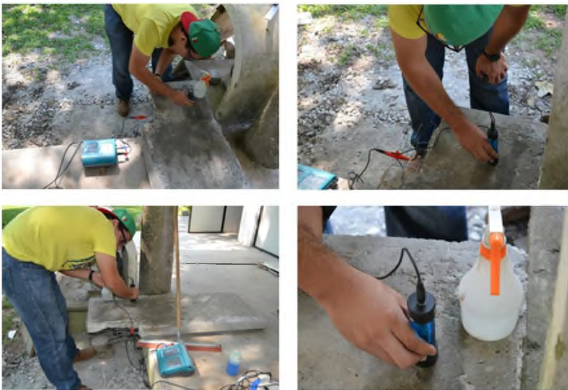
Fig. 13 Prueba de corrosión realizada a panel de concreto.
