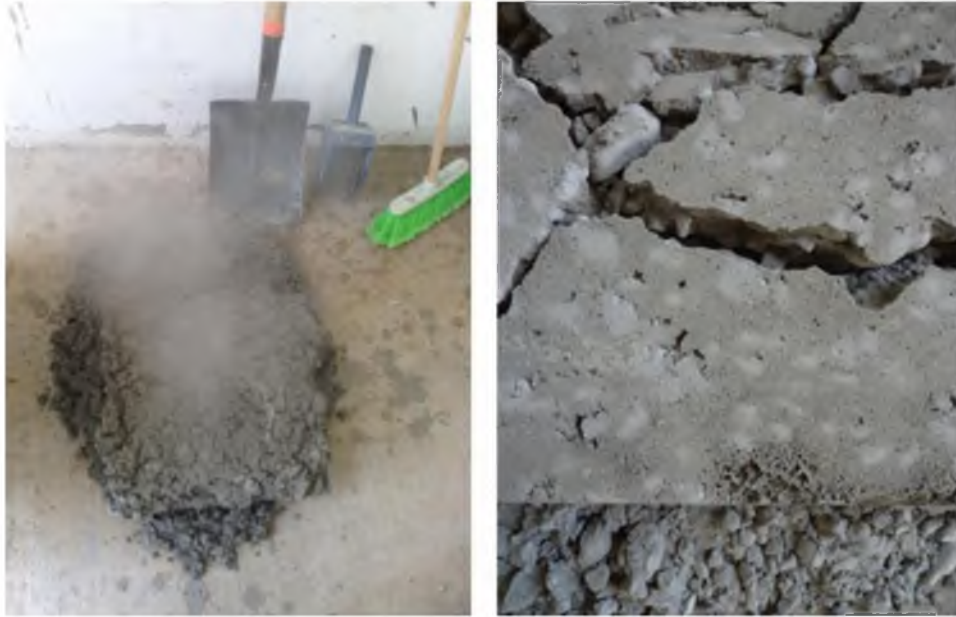
Fig.3. Reacción de la muestra con 7% de polvo de aluminio.
