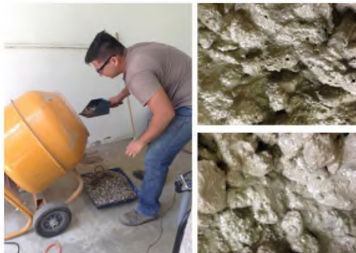
Fig. 5 Reacción de la muestra con 3% de polvo de aluminio.
