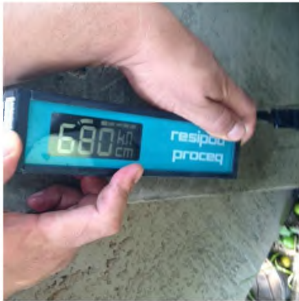
Fig. 16 Prueba de resistividad eléctrica a panel de concreto-polvo de aluminio con porcentaje a 1%.
