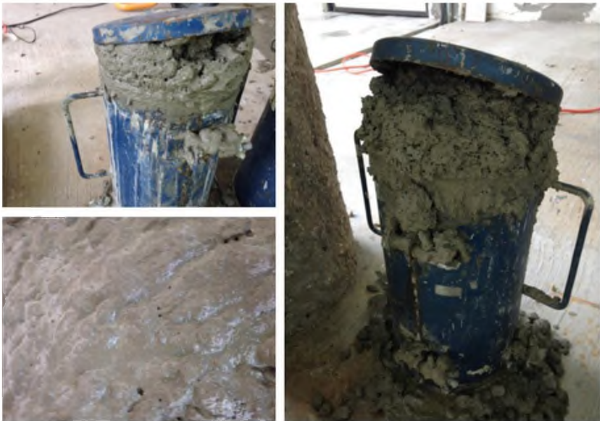
Fig. 6 Reacción de la muestra con 1% de polvo de aluminio.
