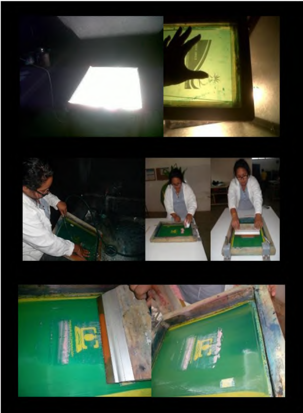
Figura 15. Impresión y aplicación de la pasta madre con el colorante extraído sobre las mallas reveladas.
