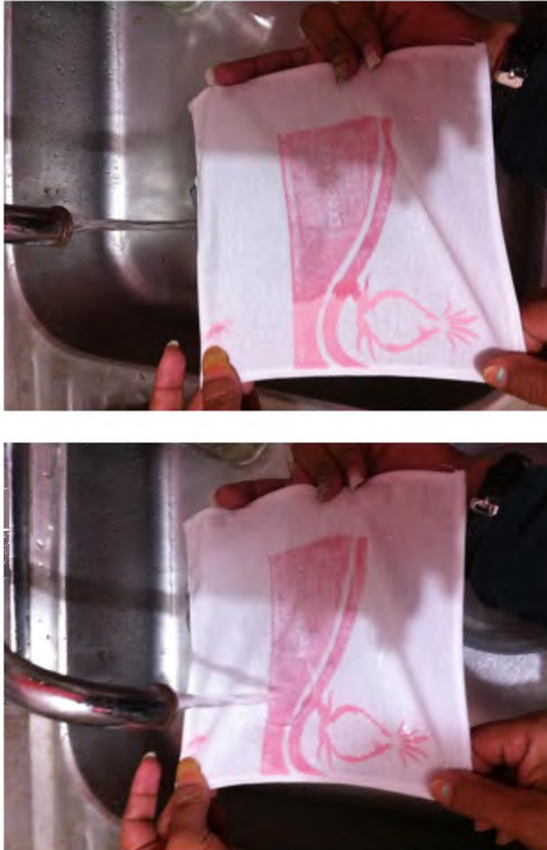
Figura 29. Prueba agua sobre textil de acuerdo a la norma mexicana NMX-A-070-INNTEX-1999.
