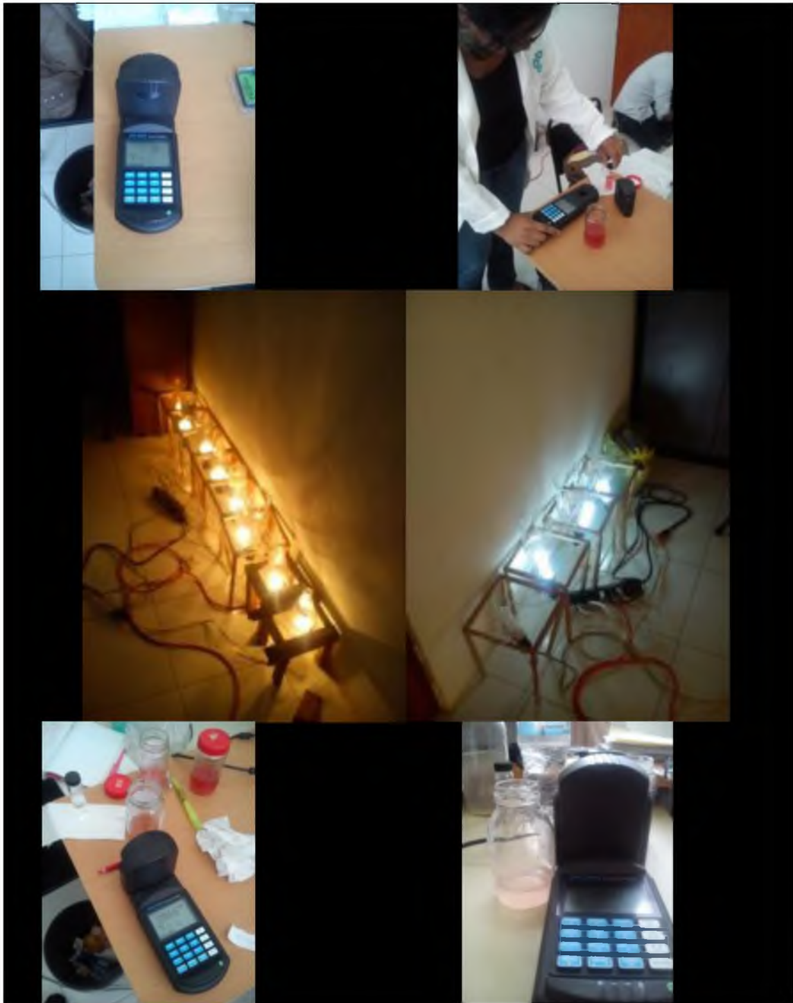
Figura 20. Proceso degradación del colorante en focos de 75,60 y 25 Watts en un transcurso de 42 horas.
