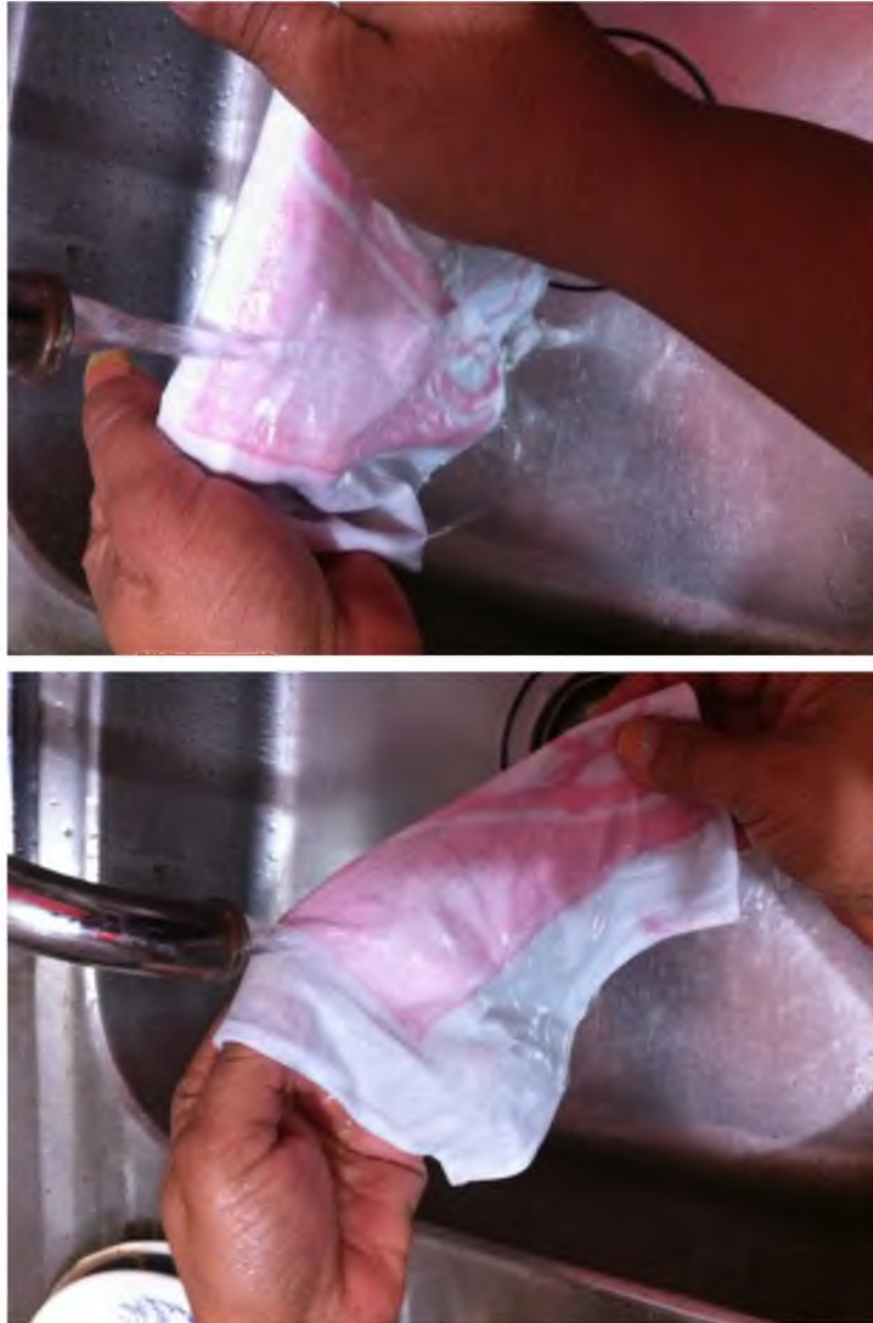
Figura 28. Prueba al lavado domestico sobre textil de acuerdo a la norma mexicana NMX-A-073-INNTEX-1995.
