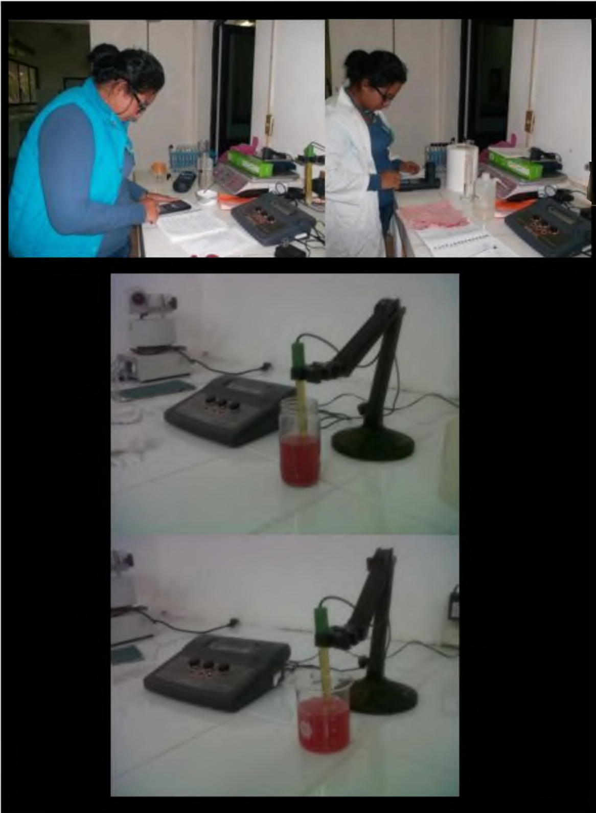
Figura 16. Medición del pH de las 2 tonalidades del colorante extraído de maíz negro y morado.
