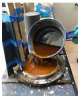
Figura 49. Vaciado de azufre en plato para cabeceo. Fuente propia
