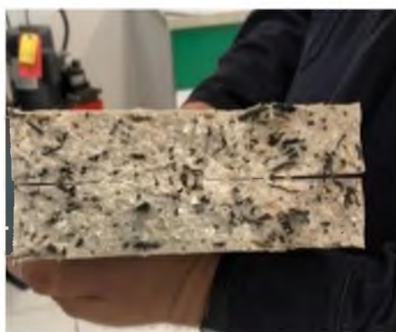
Figura 59. Muestra de 50 cm de largo x 10 cm de ancho x 2.5cm de alto de concreto polimérico con caucho de desecho en fibra a un 10% con fractura transversal. Fuente propia
