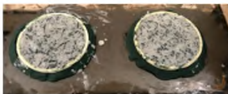
Figura 39. Concreto polimérico con caucho de desecho en fibra a un 10% en molde de PVC de 5 cm de diámetro. Fuente propia
