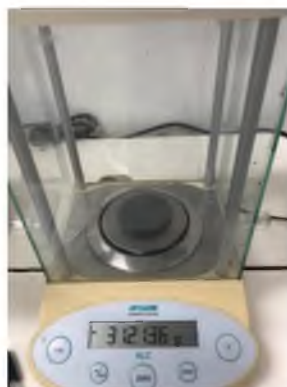
Figura 45. Peso de muestra de 5 cm de diámetro x 0.5 cm de alto de concreto polimérico con caucho de desecho en polvo a un 25% después de estar en agua 24 horas. Fuente propia
