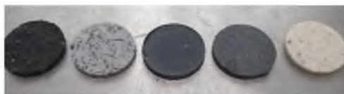
Figura 40. Muestras de 5 cm de diámetro x 0.5 cm de alto de concreto polimérico con caucho de desecho en diferentes proporciones. Fuente propia
