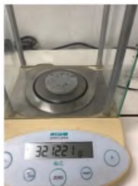
Figura 46. Peso de muestra de 5 cm de diámetro x 0.5 cm de alto de concreto polimérico con caucho de desecho en fibra a un 10% después de estar en agua 24 horas. Fuente propia
