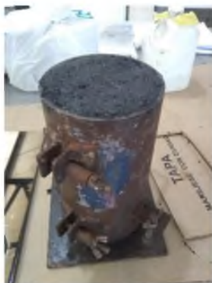
Figura 14. Concreto polimérico con caucho reciclado a un 25% en molde cilíndrico. Fuente propia
