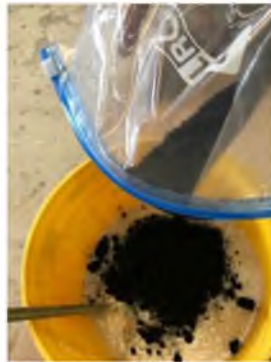
Figura 23. Vaciado de caucho. Fuente propia
