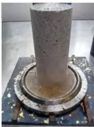
Figura 52. Muestra cilíndrica de concreto polimérico con caucho de desecho en fibra a un 10% en plato de cabeceo con azufre. Fuente propia
