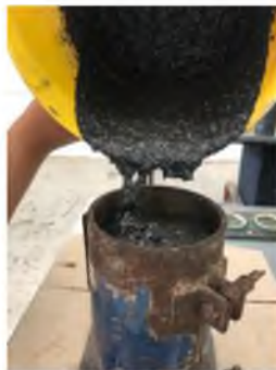
Figura 31. Vaciado de la mezcla de concreto polimérico con caucho de desecho a un 5%. Fuente propia
