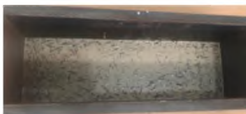
Figura 57. Muestra de 50 cm de largo x 10 cm de ancho x 2.5cm de alto de concreto polimérico con caucho de desecho en fibra a un 10%. Fuente propia
