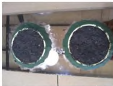
Figura 15. Concreto polimérico con caucho reciclado a un 25% en molde de PVC de 5 cm de diámetro. Fuente propia
