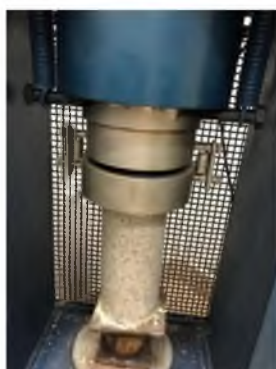
Figura 55. Muestra cilíndrica de concreto polimérico con caucho de desecho en fibra a un 10% dentro de la prensa hidráulica. Fuente propia
