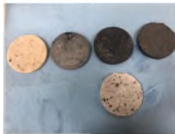
Figura 44. Muestras de 5 cm de diámetro x 0.5 cm de alto de concreto polimérico con caucho de desecho en diferentes proporciones después de 24 horas dentro de agua. Fuente propia
