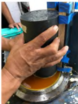
Figura 50. Muestra cilíndrica de concreto polimérico con caucho de desecho en plato de cabeceo con azufre. Fuente propia
