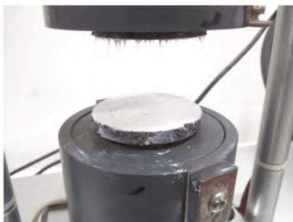
Figura 64. Muestra de 5 cm de diámetro x 0.5 cm de alto de concreto polimérico con caucho de desecho en polvo a un 25% dentro del medidor de conductividad térmica. Fuente propia
