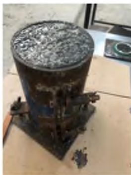
Figura 32. Concreto polimérico con caucho de desecho a un 5% en molde cilíndrico. Fuente propia
