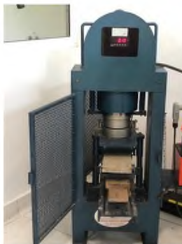
Figura 58. Muestra de 50 cm de largo x 10 cm de ancho x 2.5cm de alto de concreto polimérico con caucho de desecho en fibra a un 10% dentro de la prensa hidráulica. Fuente propia
