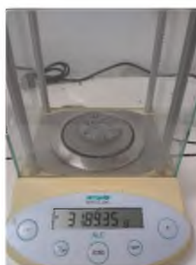
Figura 41. Peso de muestra de 5 cm de diámetro x 0.5 cm de alto de concreto polimérico con caucho de desecho en fibra a un 10%. Fuente propia
