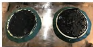
Figura 26. Concreto polimérico con caucho reciclado a un 10% en molde de PVC de 5 cm de diámetro. Fuente propia
