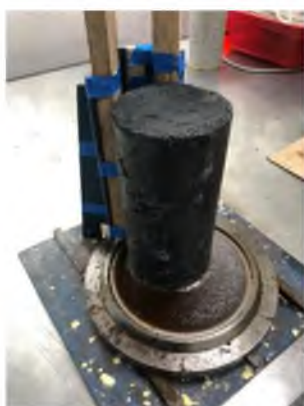
Figura 51. Muestra cilíndrica de concreto polimérico con caucho de desecho a un 25% en plato de cabeceo con azufre. Fuente propia
