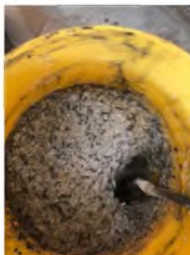
Figura 37. Mezcla de los materiales con caucho en fibra. Fuente propia
