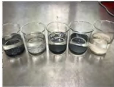
Figura 43. Muestras de 5 cm de diámetro x 0.5 cm de alto de concreto polimérico con caucho de desecho en diferentes proporciones dentro de recipientes con agua. Fuente propia
