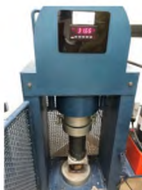
Figura 56. Muestra cilíndrica de concreto polimérico con caucho de desecho en polvo a un 10% dentro de la prensa hidráulica. Fuente propia
