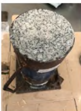
Figura 38. Concreto polimérico con caucho de desecho en fibra a un 10% en molde cilíndrico. Fuente propia
