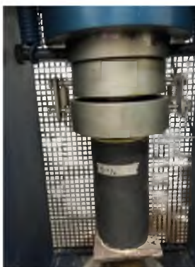
Figura 54. Muestra cilíndrica de concreto polimérico con caucho de desecho a un 5% dentro de la prensa hidráulica. Fuente propia
