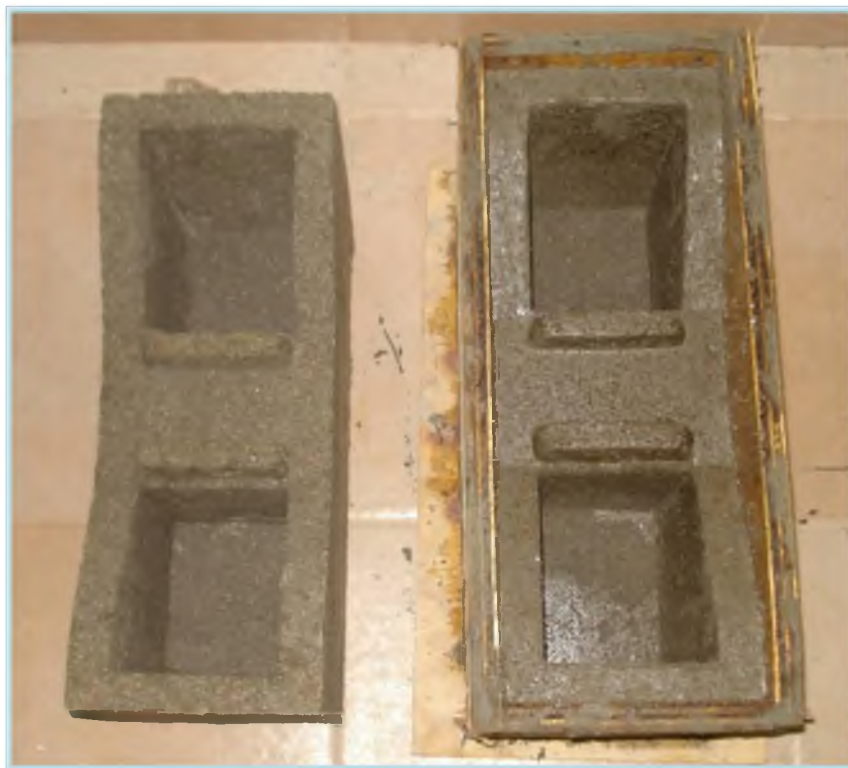
Figura 5.4 Módulo de término en base prototipo en proceso de desmolde.
