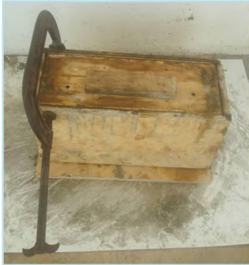
Figura 5.6. Molde asegurado con prensa.
