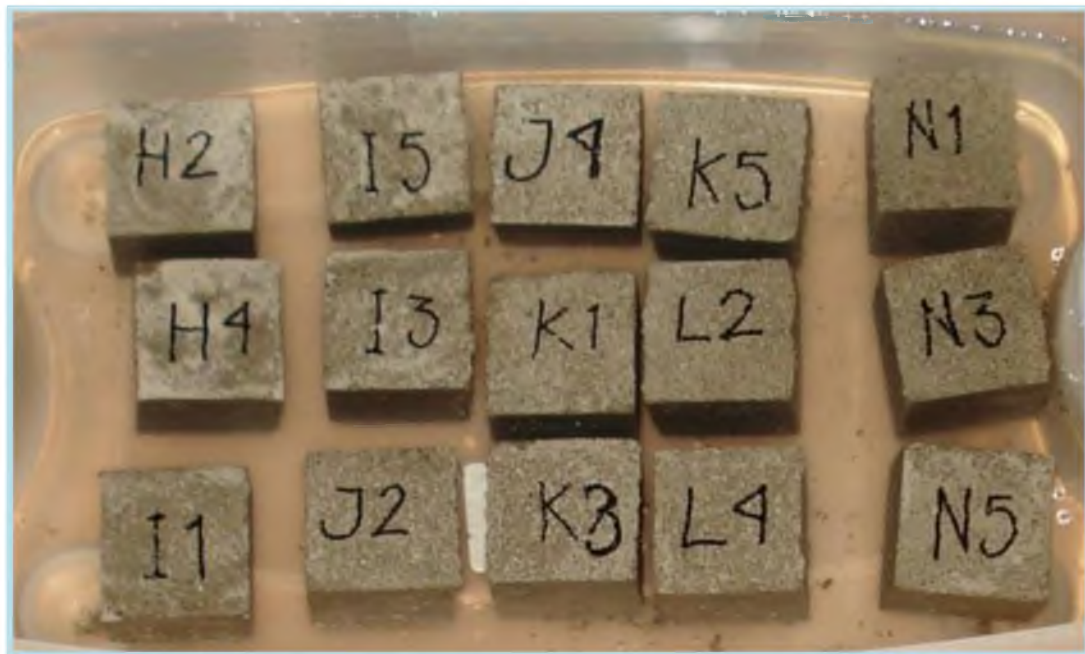
Figura 2. 4. Muestras sumergidas en agua durante el período de hidratación.
