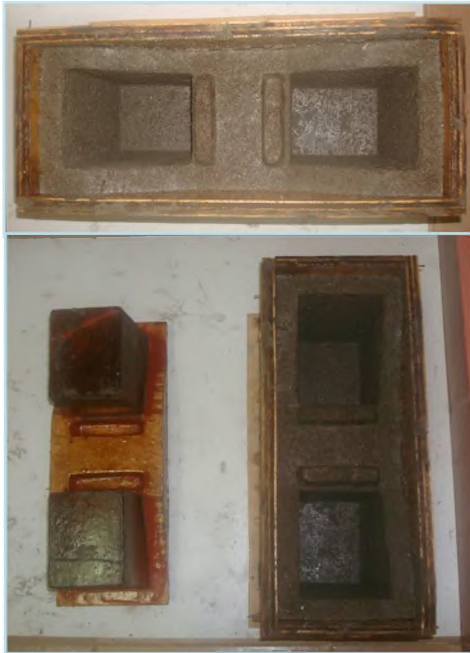
Figura 5.2. Módulo de cerramiento base en molde al inicio del proceso de desmolde (Vista Superior).
