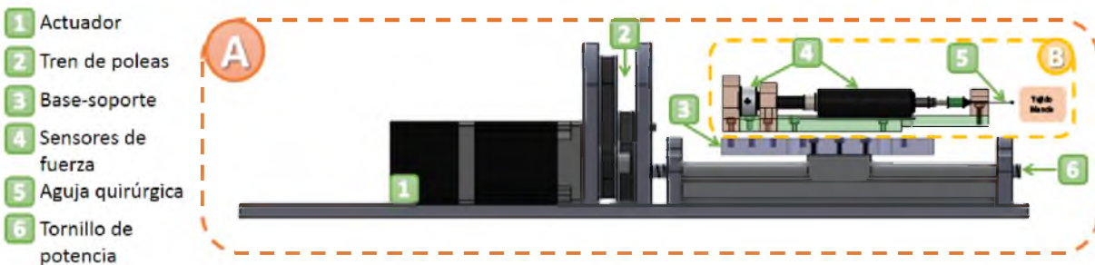
Figura 3.11: Subsistemas que componen al sistema de inserción: (A) Mecanismo Lineal, (B) Mecanismo de Inserción.
