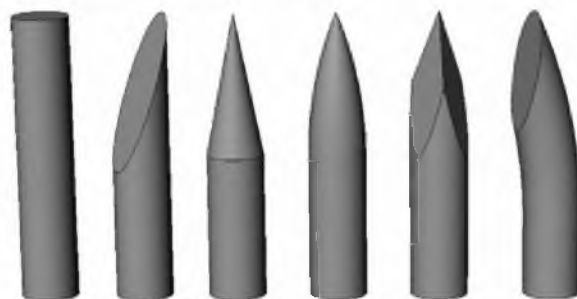
Figura 2.4: Formas básicas de la punta de la aguja (de izquierda a derecha): Roma, Biselado, Cónica, Sprotte, Diamante y Tuohy (Cortesía de van Gerwen et al. , en [27]).
