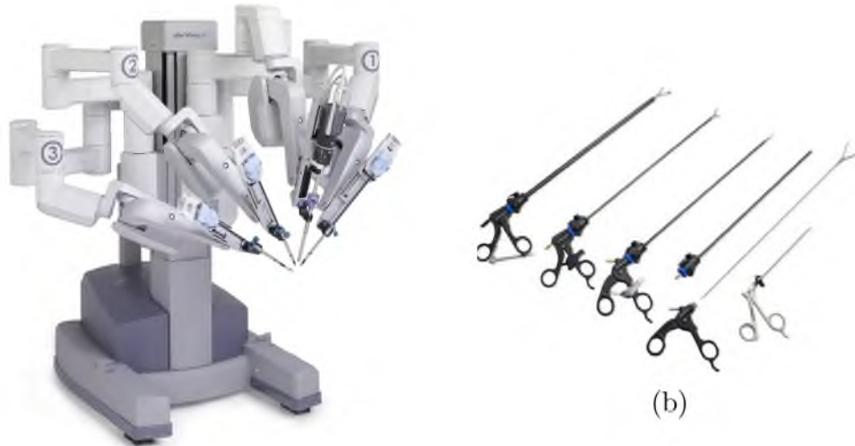
Figura 1.1: (a) Sistema quirúrgico da Vinci: Robot para cirugías (Cortesía de Intuitive Surgical, Inc.). (b) Juego de instrumentos para cirugía Laparoscópica (Cortesía de MedicalExpo Co.).
