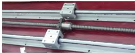
Figura 5.10: Husillo de bolas y guías lineales.
