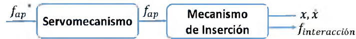
Figura 3.17: Esquema empleado en la simulación numérica para el análisis de la dinámica de interacción aguja-tejido blando.
