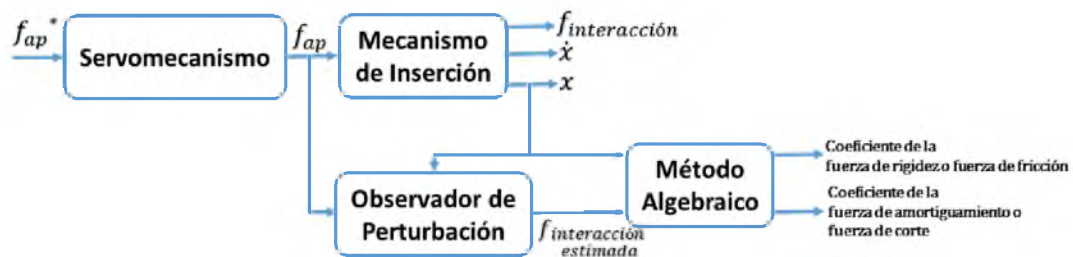
Figura 4.2: Diagrama de bloques del esquema de estimación de las fuerzas individuales de interacción mediante el método Algebraico.
