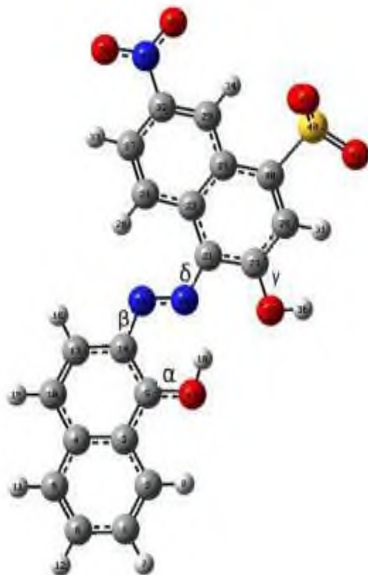
Figura 6.- Molécula de Net . Los átomos presentan los siguientes colores: rojo=oxígeno, azul=nitrógeno, gris=carbono, blanco=hidrógeno, amarillo=azufre. Las líneas continuas representan los enlaces covalentes y las discontinuas la deslocalización de los electrones.
