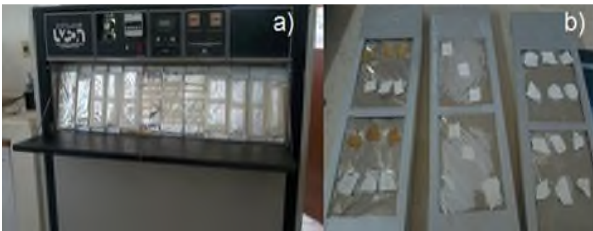
Figura 12.- (a) Imagen de la cámara de envejecimiento utilizada y (b) nanocompuestos ternarios Hule/ \text{TiO}_2 /Arcilla-modificada colocados en el portamuestras antes del proceso de envejecimiento.
