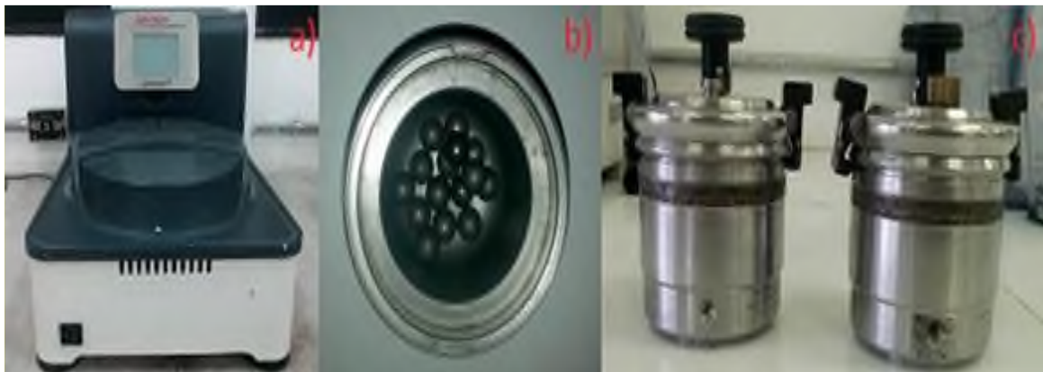
Figura 10.- (a) Molino planetario de bolas, (b) 15 bolas de 10 mm utilizadas en la molienda y (c) Tazones de acero templado.
