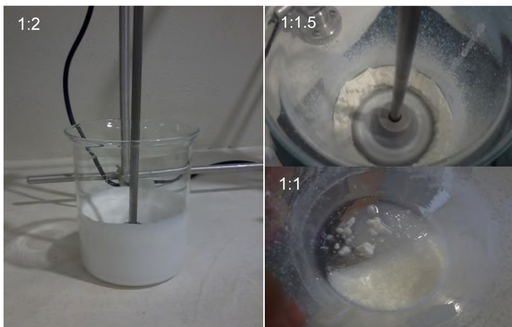
Figura 26.- Mezclado del sistema látex/TiO 2 /arcilla en relaciones 1:2, 1:1.5 y 1:1.
