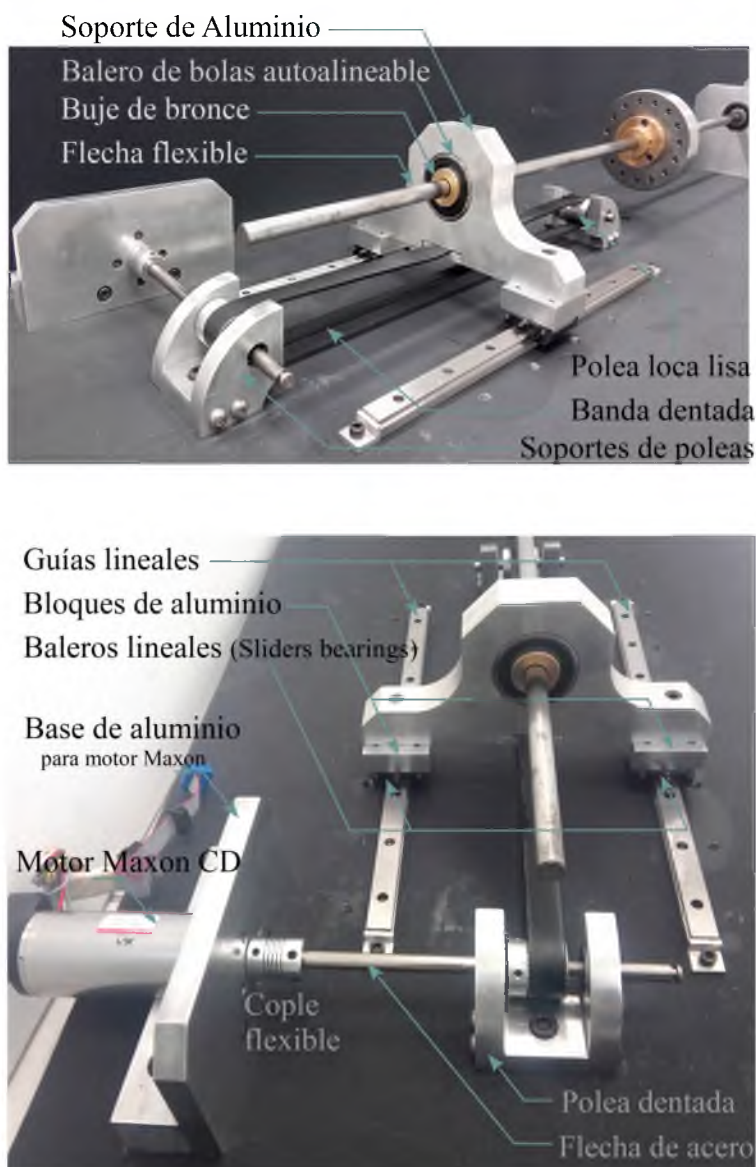
Figura 3.15: Integración de una chumacera de movimiento controlable en un sistema rotor-chumacera.
