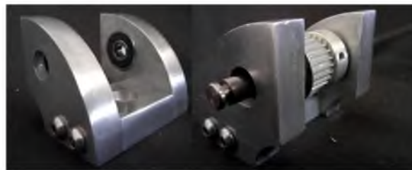
Figura 3.10: Ensamble de soportes y poleas
