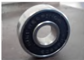
Figura 3.4: Rodamiento autoalineable FAG 2204. 2RS.TV
