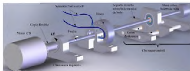
Figura 1.2: Diseño de un sistema rotor-chumacera con absorbedor de viga en cantilever[19]
