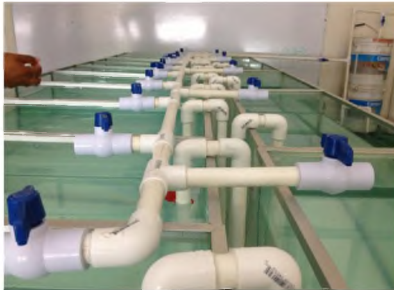
Figura 8. Sistema de recirculación cerrada compuesto por 15 acuarios con capacidad de 85 l de agua cada uno.
