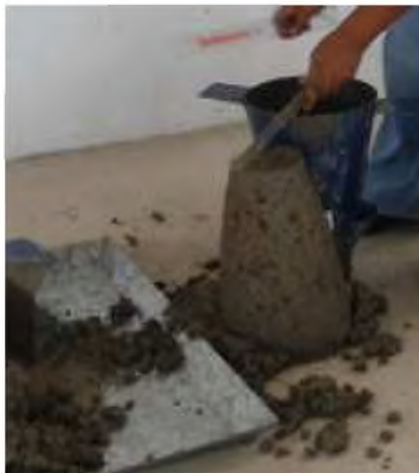
Figura 4: Prueba de revenimiento
