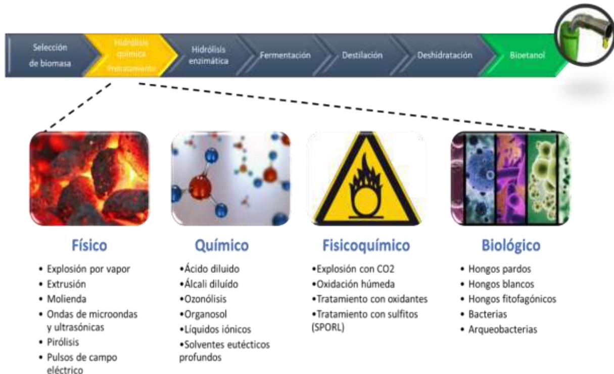
Figura 4 Panorama del procesamiento de materiales lignocelulósicos hasta la producción de bioetanol.
