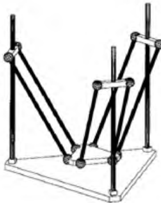
Figura 1.6: Robot Delta con articulaciones prismáticas (Xin-Jun [12])
