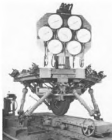
Figura 1.14: Plataforma paralela propuesta por Gough (Merlet J.P. [5])
