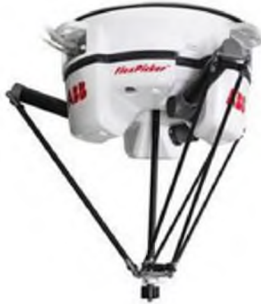
Figura 1.9: Robot Delta de ABB FlexPicker (Ángel [21]).
