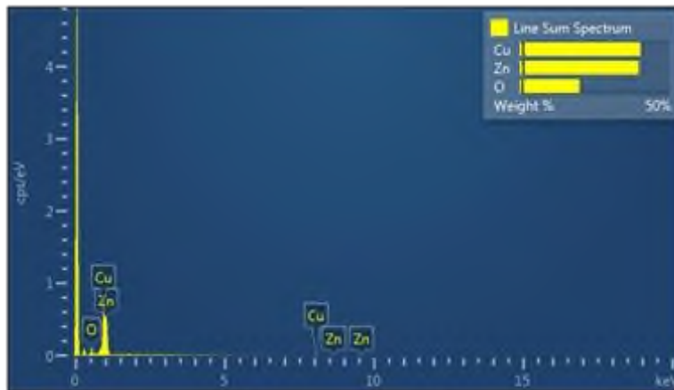
Figura 45. Espectro típico de EDS para la muestra PRHS.
