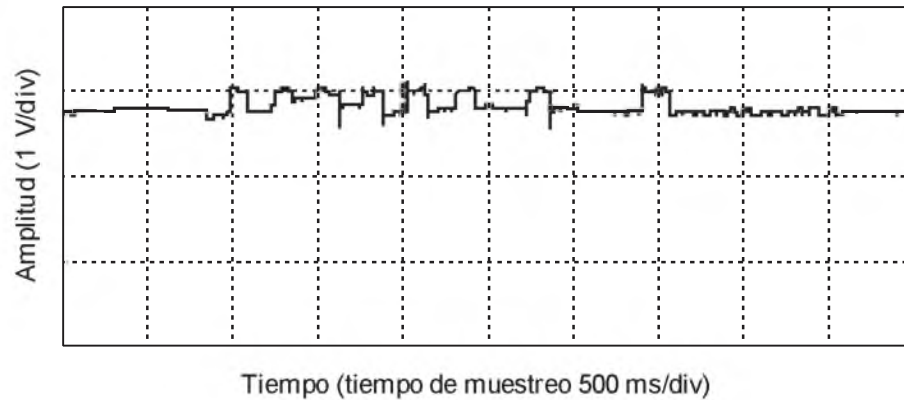
Figura 4.6. Amplitud de salida del primer arreglo interferométrico al aplicarle 3 Newtons de fuerza a un trozo del lazo.
