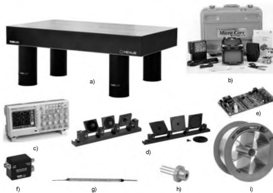
Figura II.1. a) Mesa tipo Holográfica, b) Empalmadora para fibra óptica, c) Osciloscopio, d) Controladores de polarización de tres paletas (27 mm y 56 mm), e) Controlador de láser, f) Detector para fibra óptica, g) Acoplador de fibra óptica 50/50 a una longitud de onda de 980 nm, h) Diodo láser a una longitud de onda de 980 nm, i) Fibra óptica monomodo a una longitud de onda de 980 nm.
