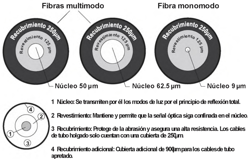
Figura 1.1. Componentes de la fibra óptica.
