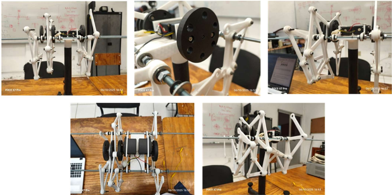
Figura 4. Ensamblado de las articulaciones y motores.
