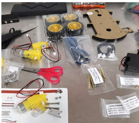
Figura 2. Piezas del ELEGOO Smart Robot Car.
