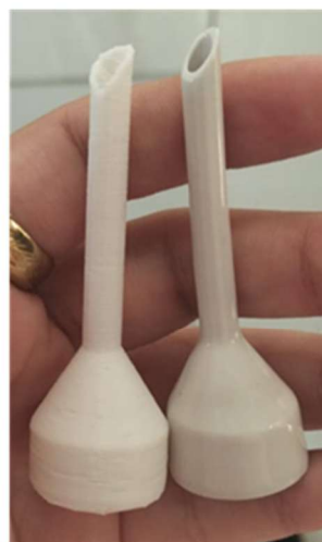
Figura 4. Embudo de vacío de porcelana (derecha) y de PLA (izquierda).
