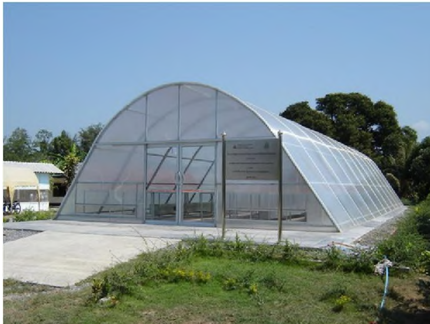
Figura 2.12 Secador solar tipo invernadero diseñado por Janjai (2012).
