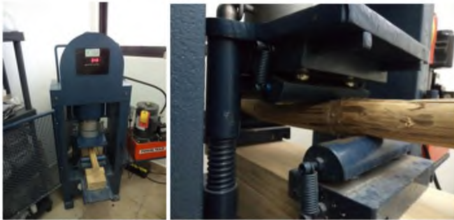
Figura 11: bambú sometido a prueba de flexión, en esta imagen se muestra como el bambú obtiene un ligero pandeo durante la realización de la prueba.
