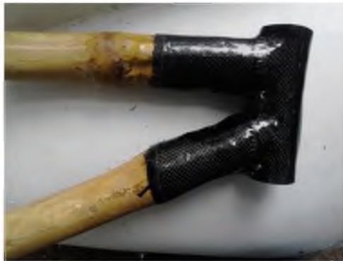
Figura 16: Resultado final de practica de unión fibra-bambú.
