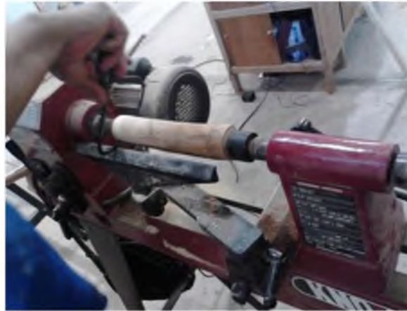
Figura 31: Trabajo de torneado para estandarizar el diámetro.
