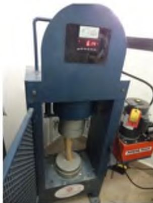
Figura 10: bambú siendo sometida a la prueba de compresión, la maquina registro su resistencia máxima.
