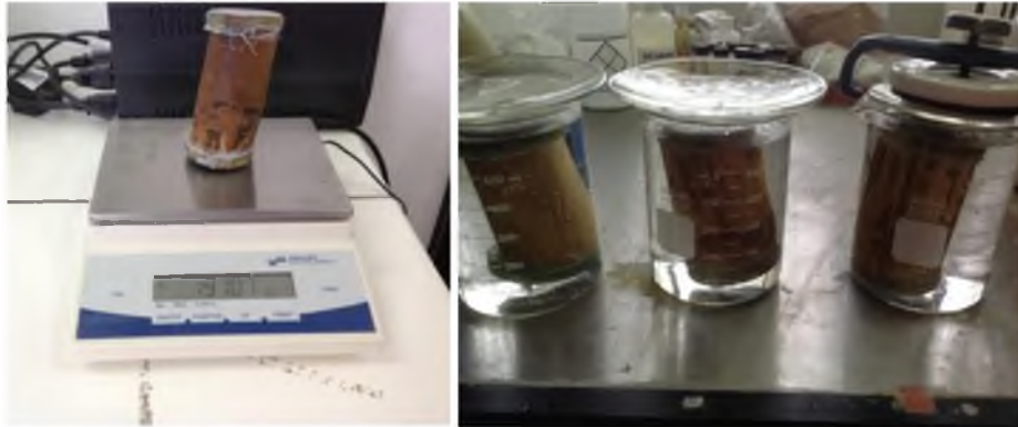
Figura 13: Pesado de la muestra de bambú, y sumergido en agua para la prueba de absorción de agua.
