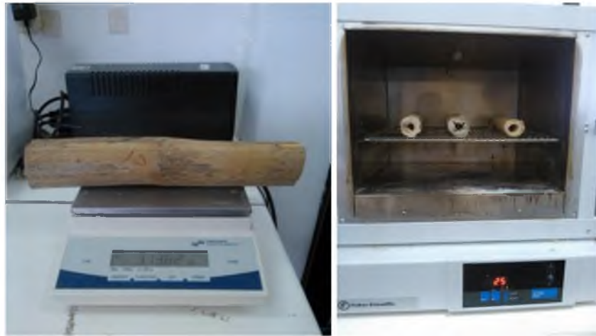
Figura 12: a) pesaje de la muestra de bambú b) sometido a prueba de humedad en el horno eléctrico.
