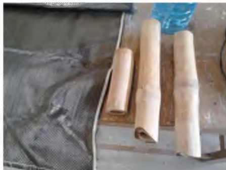
Figura 14: Piezas de bambú lijadas para hacer pruebas de unión con la fibra de carbono.
