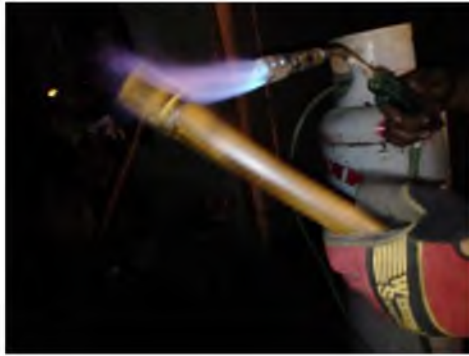
Figura 8: Aplicación de calor al bambú con soplete.
