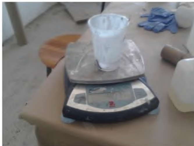
Figura 35: Preparación de la mezcla fibra-resina para el cuadro final
