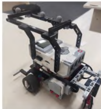
Figura 1.4: Robot móvil en configuración diferencial.
