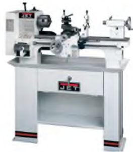
Figura 4.2: Torno convencional JET BD – 920W .
