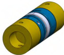
Figura 4.14: Ensamble en CAD de los coples rígidos con el cople flexible Ruland .
