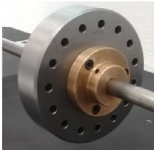
Figura 4.25: Unión de las bridas con el disco inercial y la flecha rígida.
