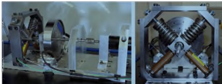
Figura 1.6: Rotor con chumacera activa, compuesta por elementos elásticos y actuadores electromagnéticos Stefan H. [10].
