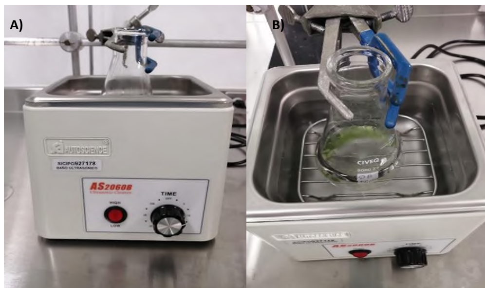
Figura 15. Extracción Asistida por Ultrasonido. a) Equipo de EUA. b) Matraz Erlenmeyer con la materia vegetal dentro del equipo EAU.
