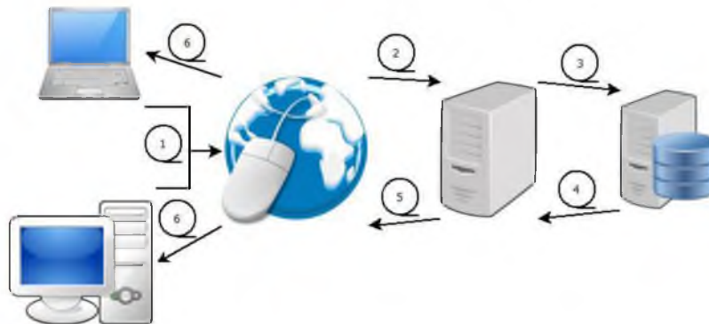
Figura 2.6 Diagrama de funcionamiento de un servidor Web . FUENTE: [50]
