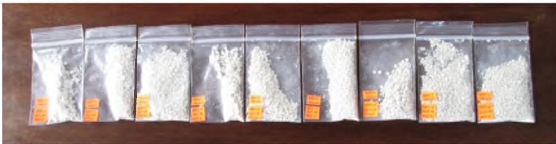
Fig. 28. Muestras cocidas a 1000°C durante 120 min. Fuente: propia.
