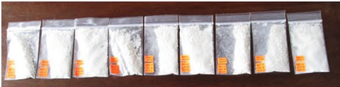
Fig. 27. Muestras cocidas a 1000°C durante 60 min. Fuente: propia.
