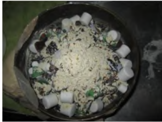
Fig.7. Tamiz con la materia molida y medios de molienda (alúminas de ¼" y ½").
