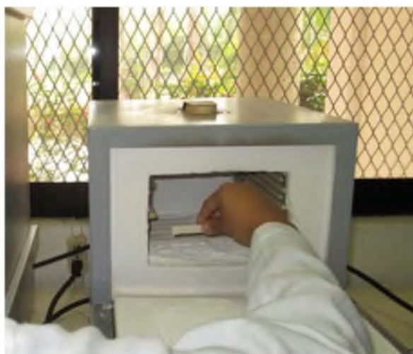
Fig. 22. Colocación de muestras en el horno Thermo Scientific Thermolyne.
