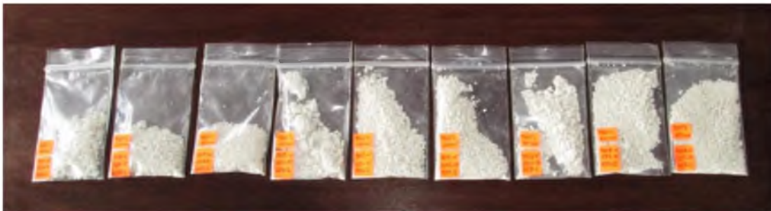
Fig. 23. Muestras cocidas a 900°C durante 60 min. Fuente: propia.
