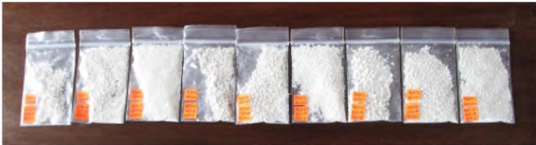
Fig. 26. Muestras cocidas a 950°C durante 60 min. Fuente: propia.
