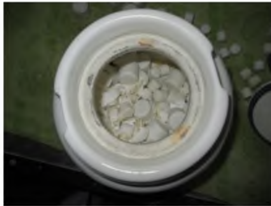
Fig. 10. Jarra de porcelana con la cáscara de huevo y medios de molienda (alúminas de \frac{1}{4} " y \frac{1}{2} " ).
