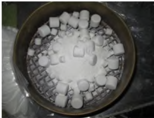
Fig. 12. Tamiz con cáscara de huevo molida y medios de molienda (alúminas de \frac{1}{4} " y \frac{1}{2} ").
