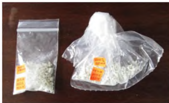
Fig. 31. Muestras cocidas a 1000°C durante 180 min. Fuente: propia.
