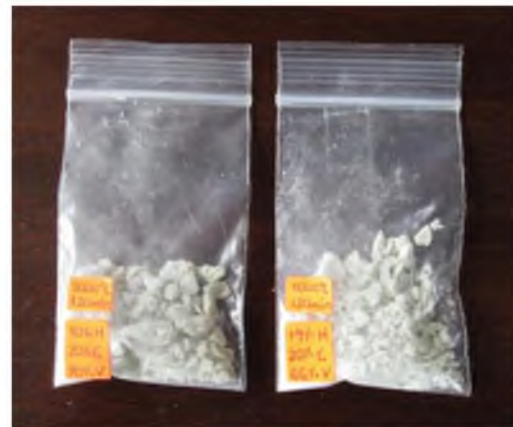
Fig. 30. Muestras cocidas a 1000°C durante 120 min. Fuente: propia.
