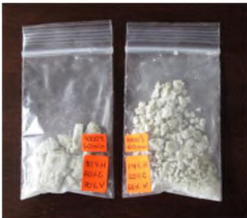
Fig. 29. Muestras cocidas a 1000°C durante 60 min. Fuente: propia.
