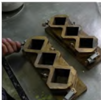
a) Preparación de moldes b) Preparación de la solución C) Preparación del mortero Fig. 13. Preparación de las probetas, fuente propia.
