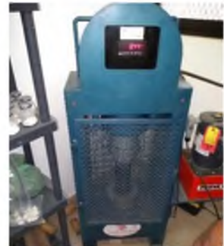
c) Ensayo a compresión
