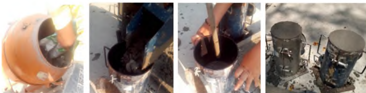
a) Preparación b) Llenado c) Compactación d) Probetas terminadas
