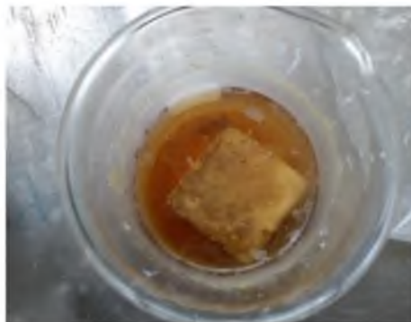
Fig. 17. Curado en una solución de \text{Ca}(\text{OH})_2 , fuente propia.
