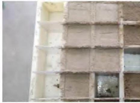
Fig. 22. Probetas de E.C.M activadas con \text{Ca(OH)}_2 , fuente propia.
