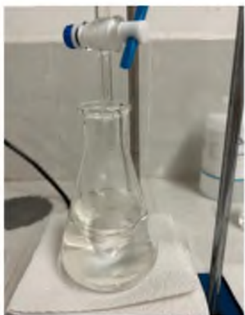
Figura 12A. Titulación con ácido clorhídrico para determinación de proteína cruda.
