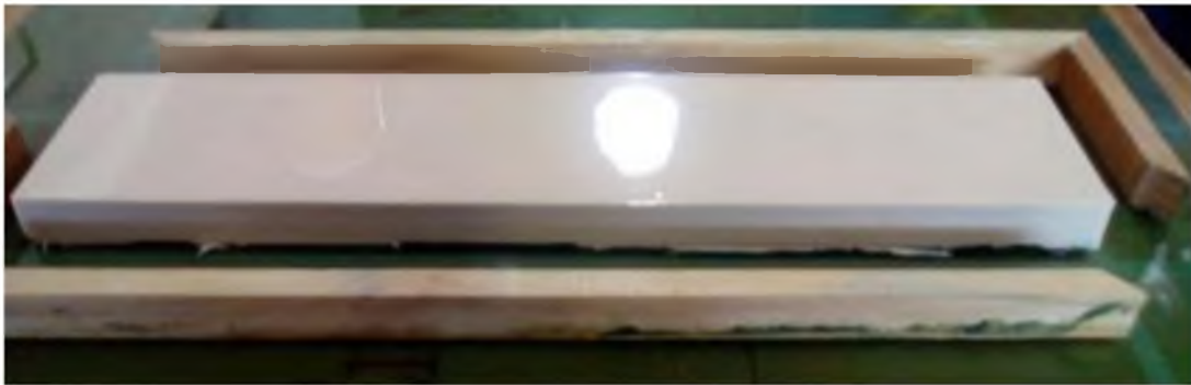
Figura 39: Momento de desmolde de la placa donde se ve la cara con geal coat, fuente propia.
