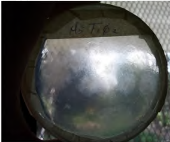
Figura 55: Muestra M5 con 2% de \text{TiO}_2 a las 48 Hrs, fuente propia.
