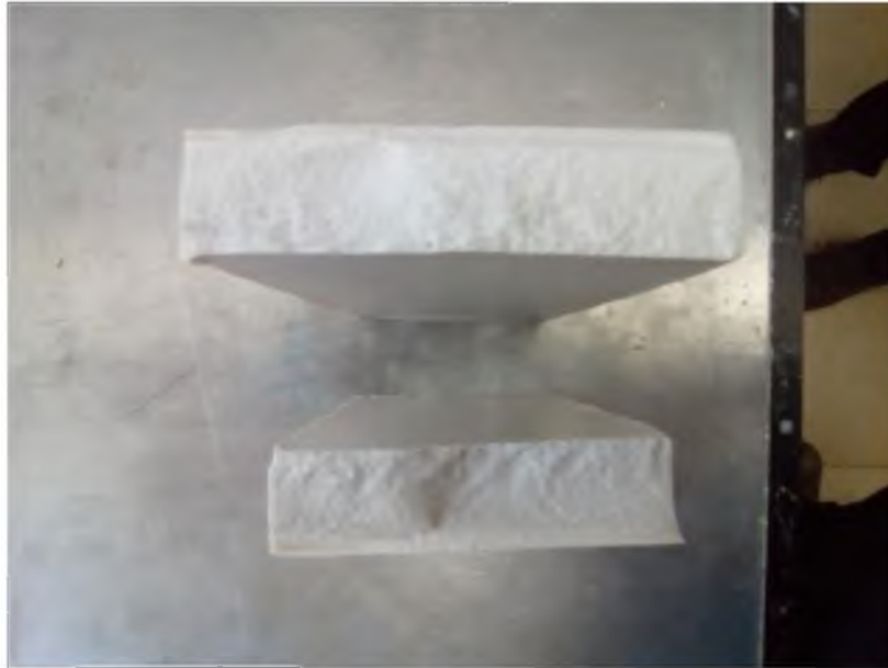
Figura 43: Fractura transversal C, fuente propia.
