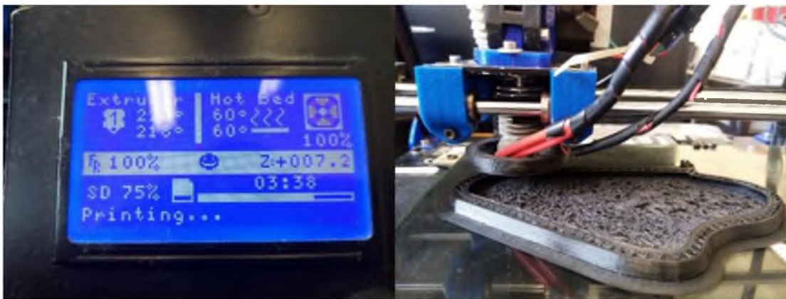
Figura 77: Modelo al 75% de la impresión, empezando el cierre del modelo, fuente propia.
