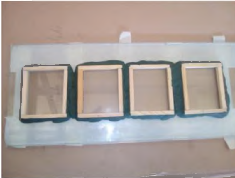
Figura 34: Fijado de marcos en vidrio, fuente propia.
