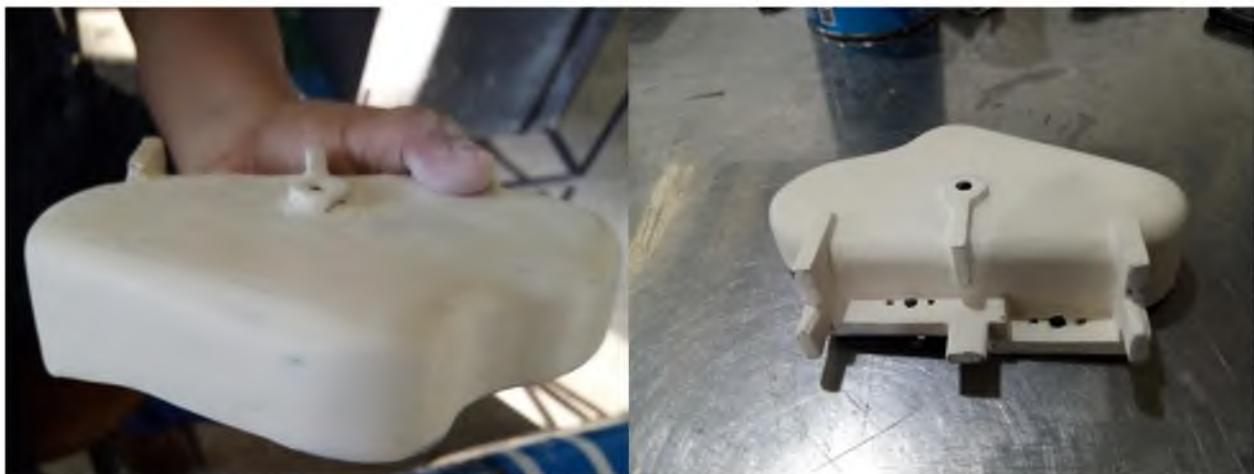
Figura 80: Proceso de lijado donde se ocuparon lijas de diferentes granos, fuente propia.
