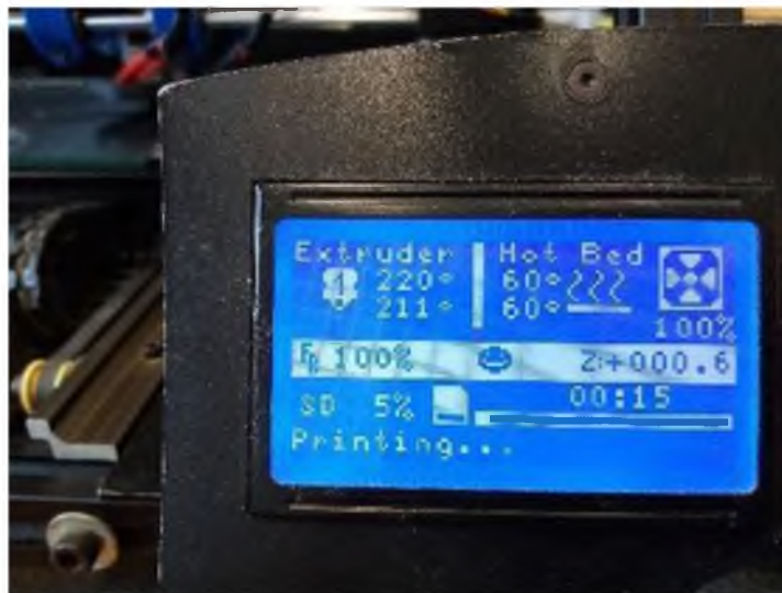
Figura 74: Selección de temperaturas para el extrusor (220°) y la cama (60°), fuente propia.
