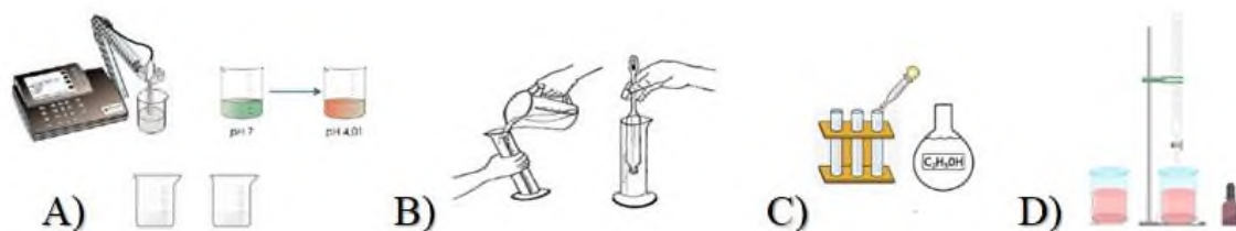
Figura 3. Pruebas de plataforma en leche fresca. A) potencial de hidrógeno, B) densidad, C) prueba de alcohol y D) acidez titulable.
