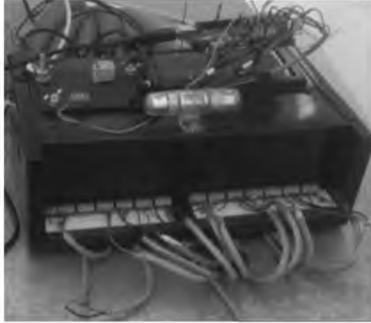
Fig. 3.26 Dispositivo de adquisición de datos y control del motor.
