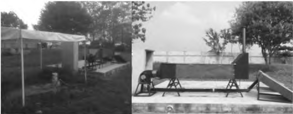
Fig. 2.11 Secador solar tipo túnel instalado.
