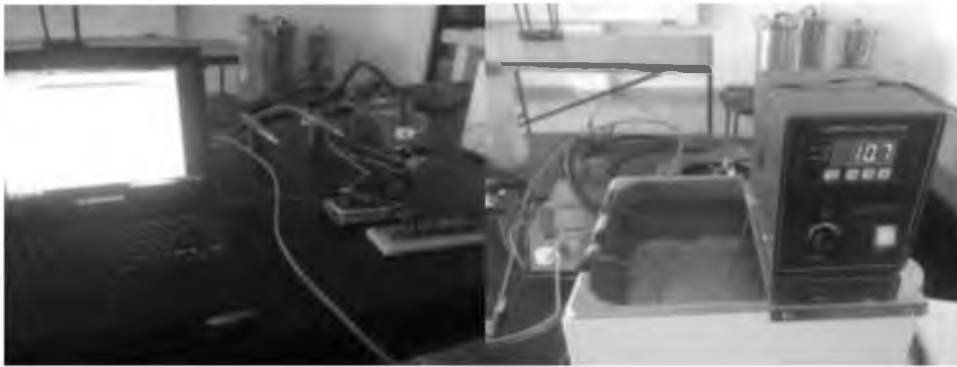
Fig. 3.11 Calibración de termopares por medio de un baño térmico.
