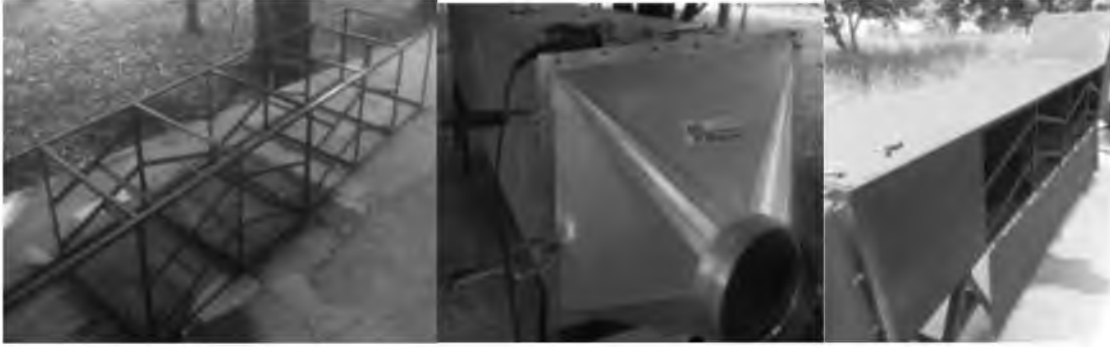
Fig. 2.8 Construcción del túnel de secado
