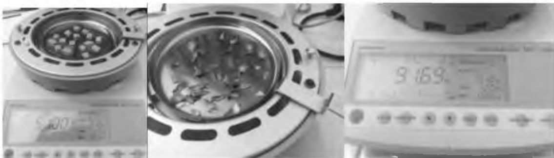
Fig. 5.1 Determinación de la humedad en la col.
