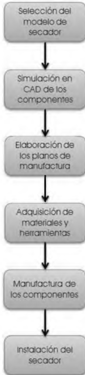
Fig. 2.5 Diagrama del proceso de construcción del secador solar.
