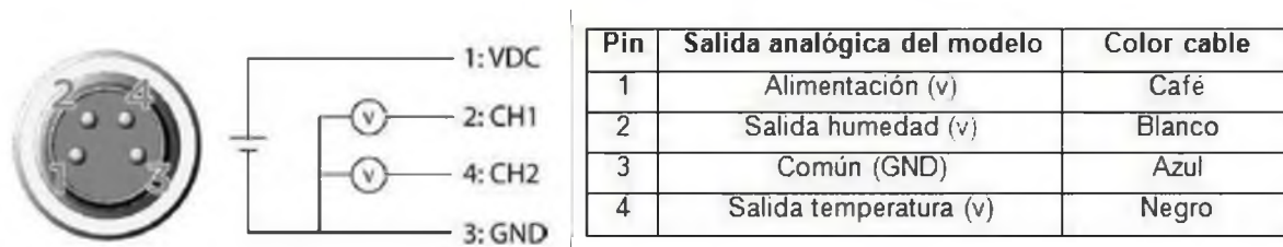
Fig. 3.2 Diagrama de conexión del sensor HMP60 [32].
