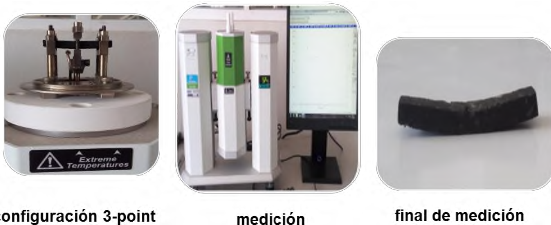
Figura 4.10. Medición en DMA de composito de materia prima secundaria.
