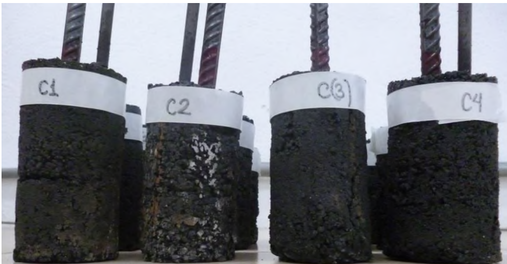
Figura 5.7. Muestras cilíndricas reforzadas con varilla.
