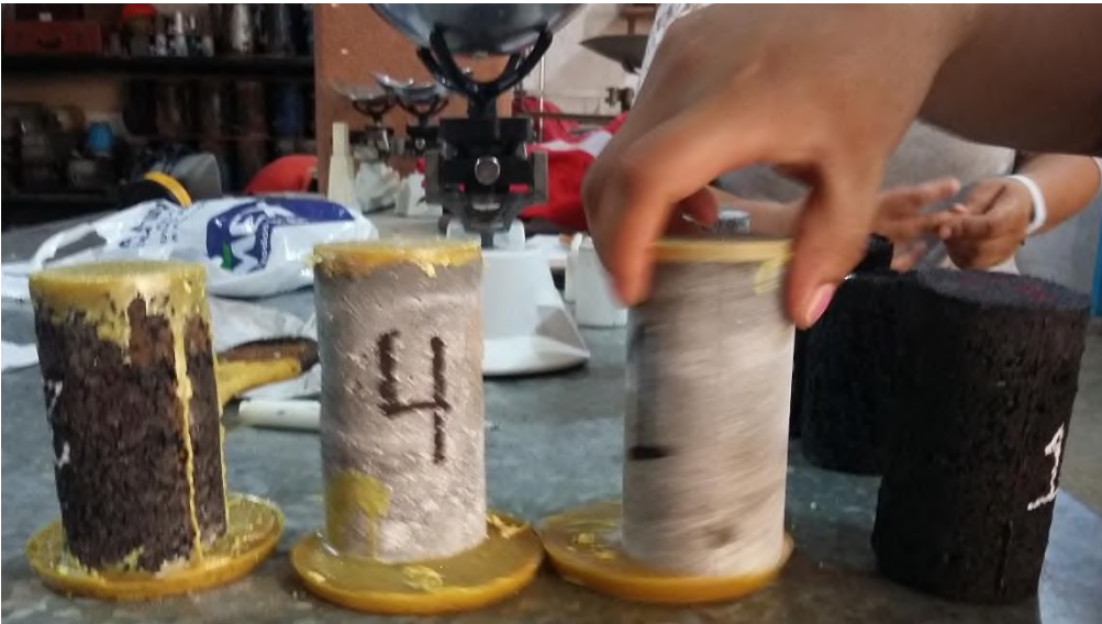
Figura 5.8. Muestras cilíndricas de 28 días de edad preparadas según ASTM C 617.
