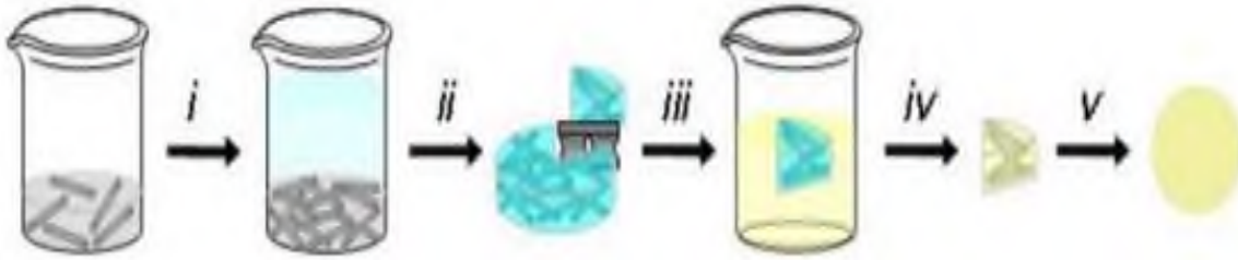
Figura 2.1 Compuesto de polímero reforzado con fibras de celulosa por método de intercambio de solvente; i) Dispersión de las fibras, ii) Intercambio de solvente, iii) Fibra gelificada + solución polimérica, iv) Secado, v) Compuesto compactado [12].
