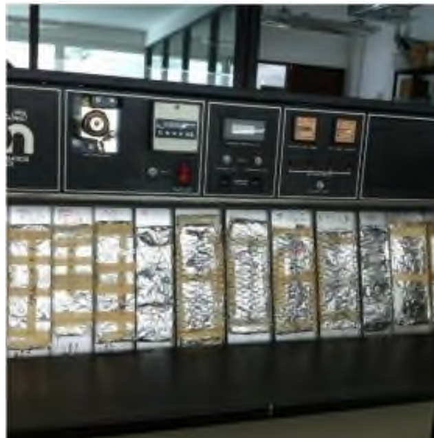
Figura 4.12. Cámara ambiental de envejecimiento acelerado.
