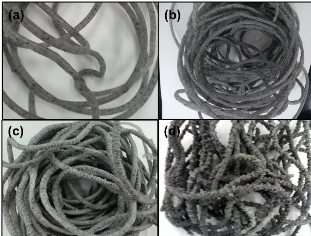
Figura 17. Materiales compuestos EVA18/ Mg_b a diferente contenido del material metálico Mg_b ; (a) 5, (b) 10, (c) 20 y (d) 40 %.
