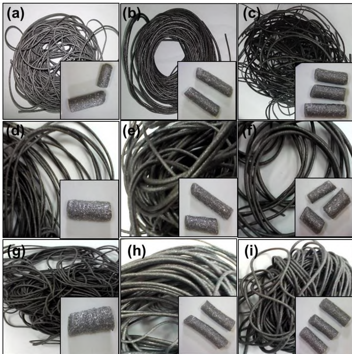
Figura 35. Imágenes de los materiales compuestos con Mg metálico: (a, b y c) EVA18Mg con E1, E2 y E3; (d, e y f) EVA28Mg con E1, E2 y E3 y (g, h y i) EVA40Mg con E1, E2 y E3.
