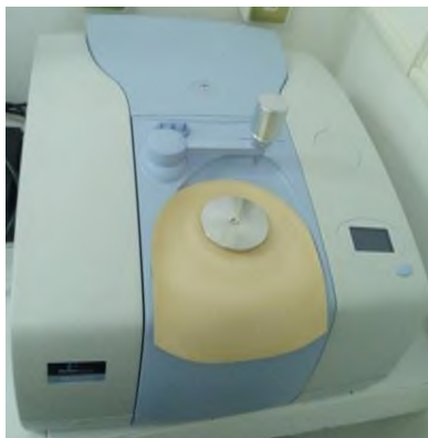
Figura 71. Espectrómetro infrarrojo modelo Spectrum 100 de la compañía Perkin Elmer.
