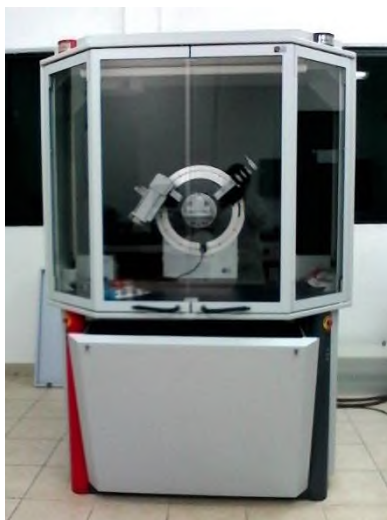
Figura 73. Difractómetro de rayos x, modelo: D8 Advance, marca: Bruker AXS serie HX-L4-102.
