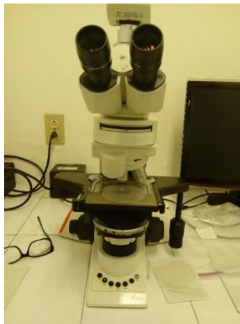
Figura 67. Microscopio óptico con contraste de fase marca Leica modelo DM 300.
