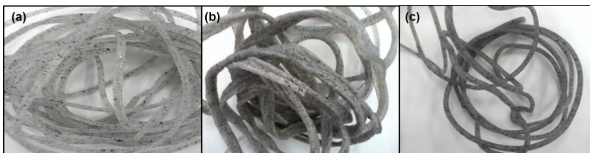
Figura 15. Materiales compuestos EVA/ Mg_b con los siguientes perfiles de temperatura: (a) T1 = 105 °C, T2 = 115 °C y T3 = 120 °C, (b) T1 = 80 °C, T2 = 85 °C y T3 = 100 °C y (c) T1 = 70 °C, T2 = 85 °C y T3 = 95 °C.
