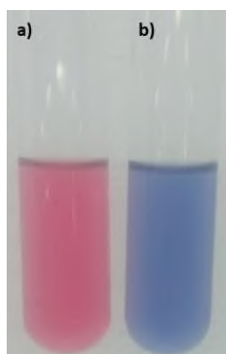
Figura 32. Extracto hidroalcohólico de los frutos de la yerba de guava; a) pH ácido, b) pH neutro.
