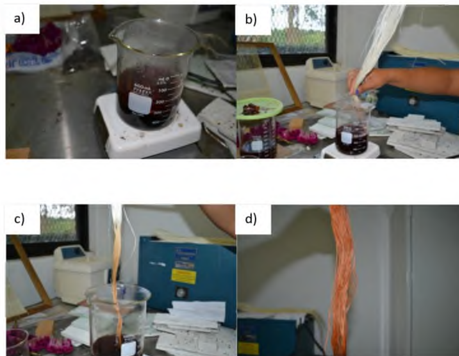
Fig. 25 Proceso de teñido de la fibra: a) Preparación del líquido a 120°C, b) sumersión de la fibra, c) expulsión de la fibra, d) fibra teñida.
