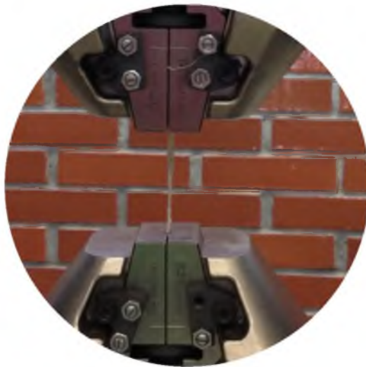
Fig. 37 Prueba de Resistencia a la tensión de la trama de 1cm x 20cm de la fibra de piña.
