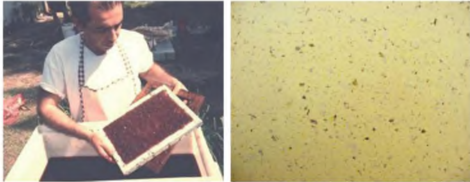
Fig. 2 Obtención del papel, mediante inmersión en suspensión de fibra de piña.
