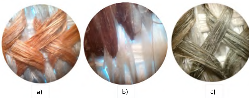
Fig. 35 Muestras obtenidas en el microscopio. (a) Fibra teñida del pigmento de achiote, (b) fibra teñida del pigmento de Jamaica, (c) fibra teñida del pigmento de hoja de flor de cempasúchil.
