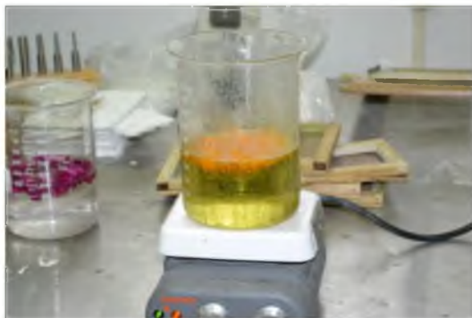
Fig. 27 Proceso de extracción de colorante a fuego lento.
