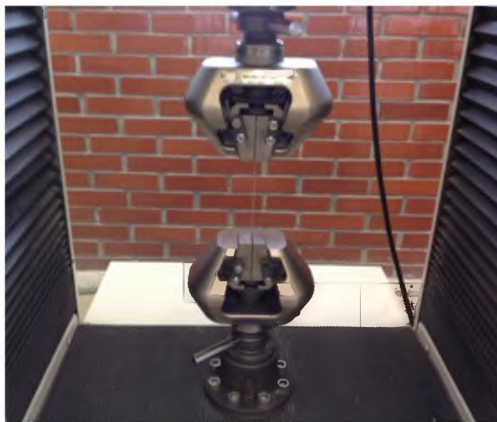
Fig. 20 Prueba de resistencia a la tensión de la fibra.
