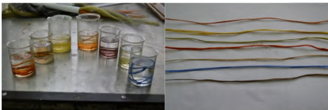
Fig. 28 Proceso de decoloración de las fibras teñidas a 1 semana.
