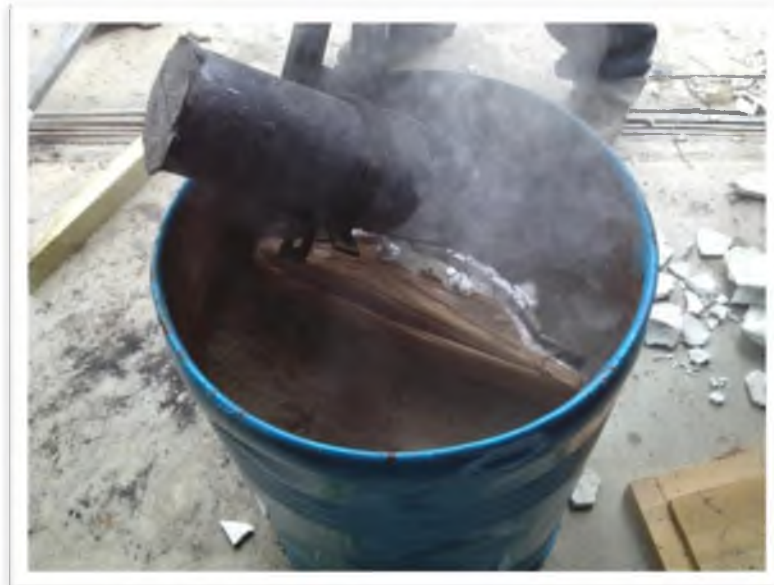
Fig. 42. Fundición del molde en aluminio. Fuente: Propia.
