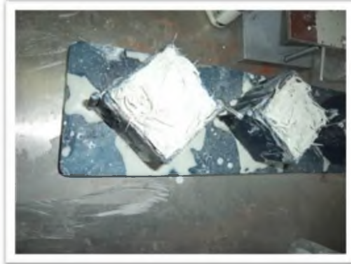
Fig. 16. Moldes con el material compuesto. Fuente: Propia.
