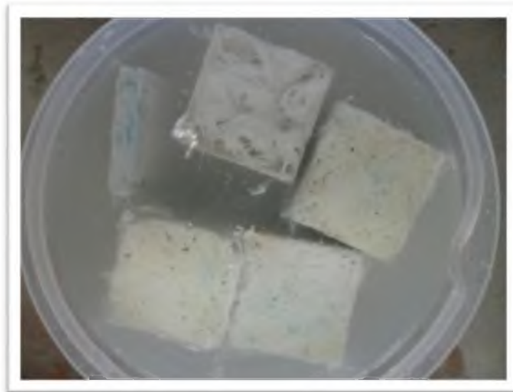
Fig. 17. Fraguado en agua de los especímenes. Fuente: Propia.
