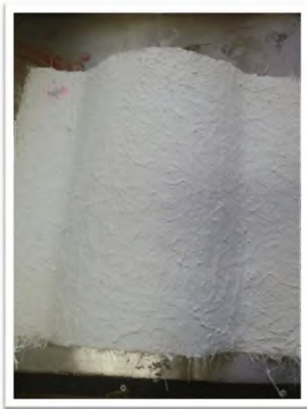
Fig. 46. Prueba con fibra de vidrio deshilada y cinco milímetros de espesor. Fuente: Propia.
