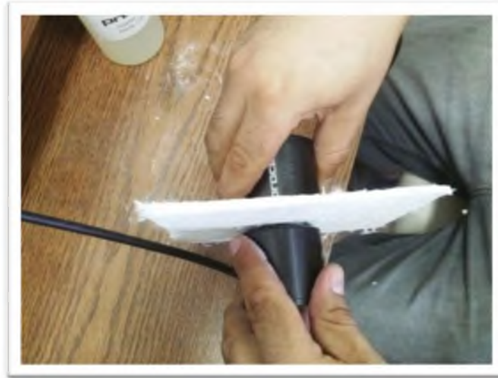
Fig. 28. Prueba ultrasónica realizada a una pieza de material compuesto concreto-fibra de vidrio. Fuente: Propia.
