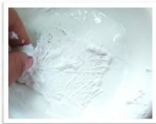
Fig. 14. Malla de fibra de vidrio sumergida en cemento blanco y agua. Fuente: Propia.
