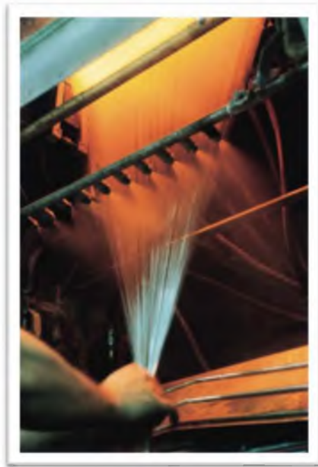
Fig. 6. Obtención de los hilos de fibra de vidrio.
