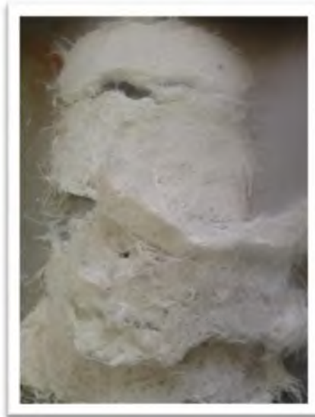
Fig. 45. Prueba con fibra de vidrio en deshilada de 10mm de espesor. Fuente: Propia.
