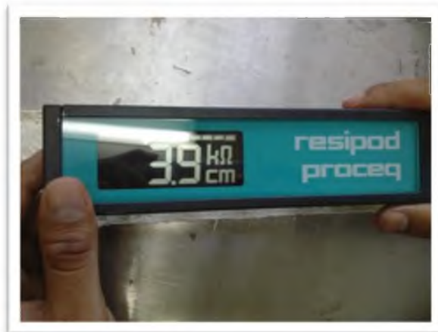
Fig. 23. Resultado de la prueba de resistividad eléctrica aplicada al material. Fuente: Propia.
