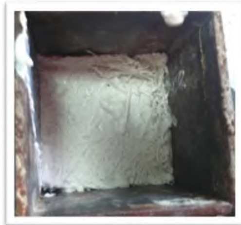
Fig. 15. Malla de fibra de vidrio colocada en el molde. Fuente: Propia.
