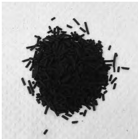
Figura 1.7. Catalizador de HDS, \text{MoS}_2 soportado en alúmina, agotado.
