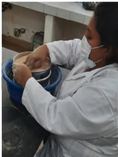
Figura 17. Tamizado de la muestra para obtener un tamaño de partícula de 250 \mu\text{m} .
