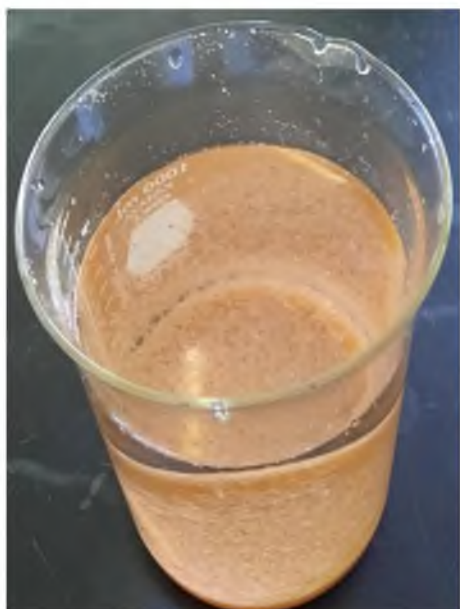
Figura 19. Lavado con agua de la llave de la muestra después de la desproteinización.
