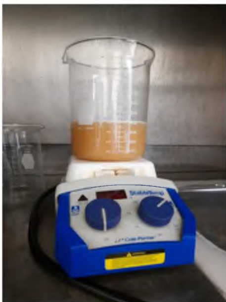
Figura 21. Desmineralización con HNCI al 4 M.
