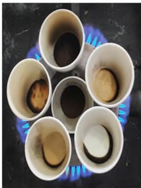
Figura 23. Determinación de minerales del quitosano sigma y quitosano obtenido.
