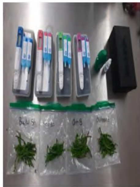
Figura 26. Medición de nutrientes en savia (fosfatos, nitrógeno, potasio, magnesio).
