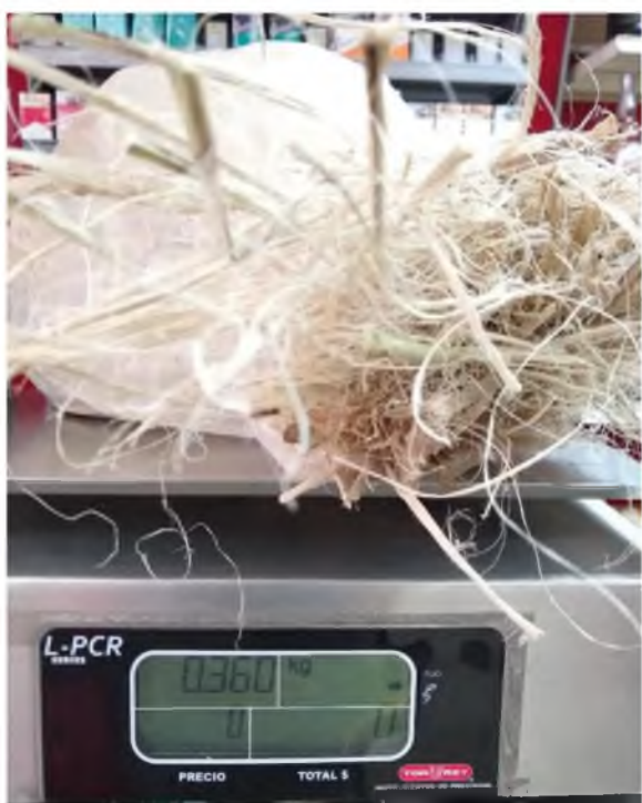
Figura 10.- Pesaje de la fibra inicial en una báscula eléctrica de precisión. Fuente propia.
