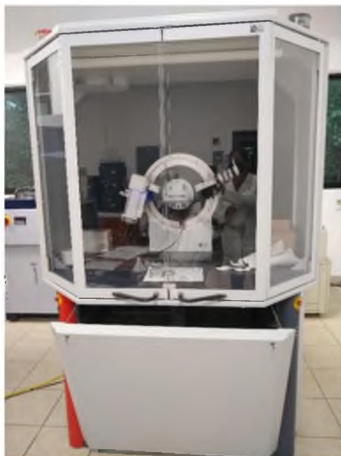
Figura 38.- Difractómetro de rayos X D8 ADVANCE BRUKER AXS. Fuente propia.
