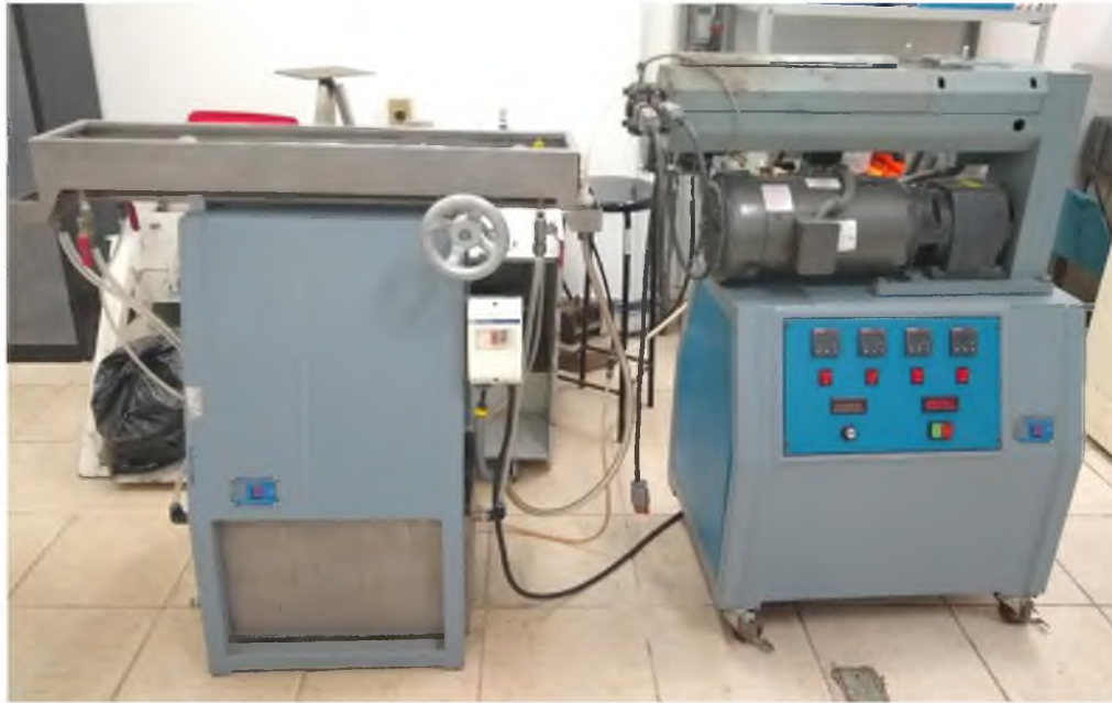
Figura 49.- Extrusora marca BEUTELSPACHER MODELO E1930, con su sistema de enfriamiento. Fuente propia.
