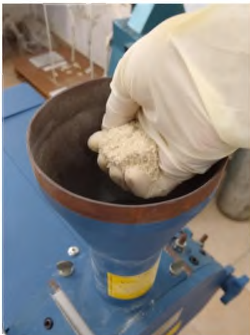
Figura 32.- Alimentación con muestra de F.N.T mediante tolva. Fuente propia.
