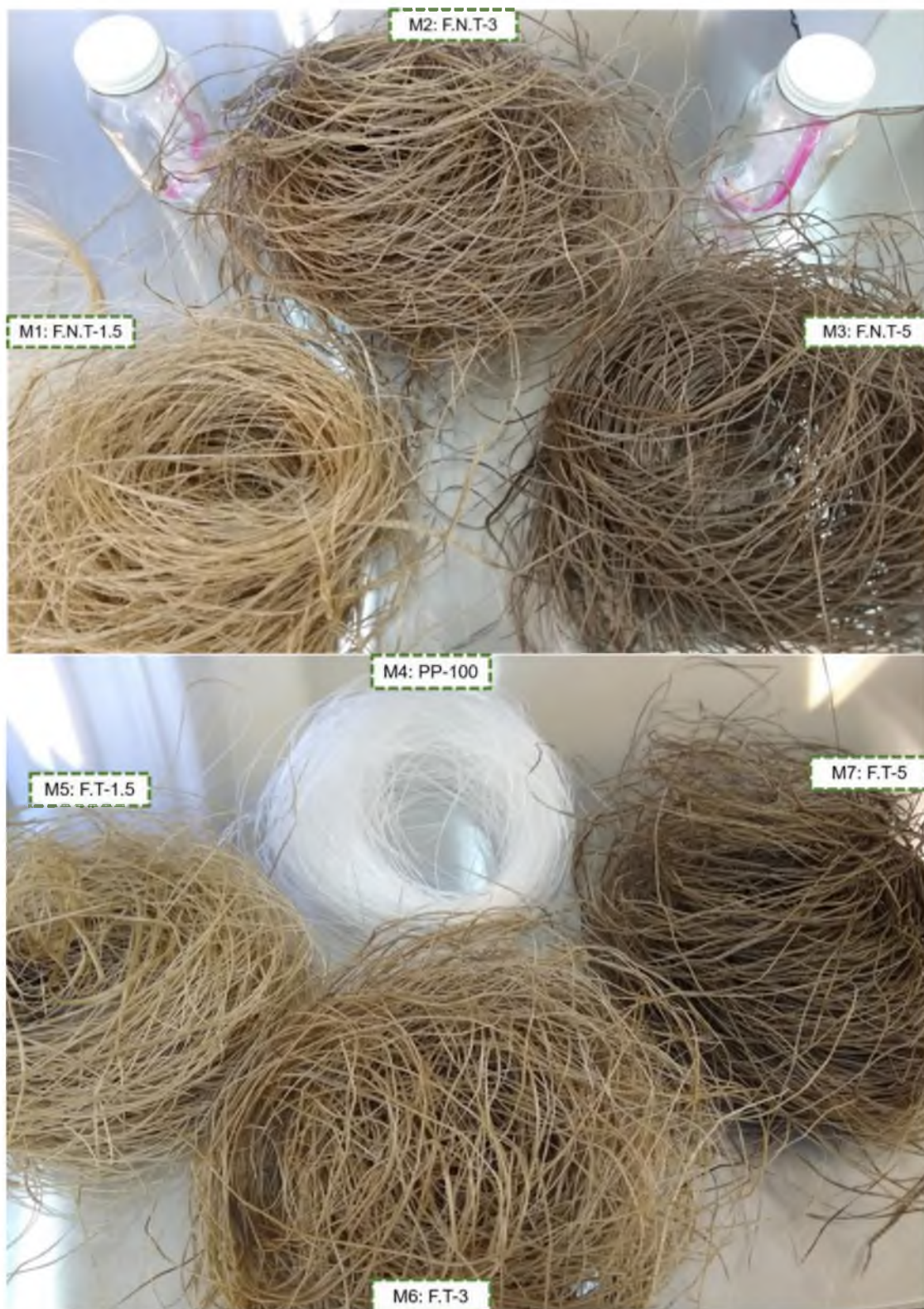
Figura 72.- a-b- Filamentos de material compuesto con matriz de PP reforzado con partículas de fibra de Agave angustifolia Haw no tratadas (F.N.T) y tratadas químicamente (F.T). Fuente propia.
