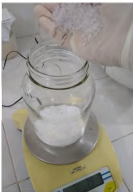
Figura 45.- Frasco tarado listo para agregar muestra de polipropileno (PP). Fuente propia.
