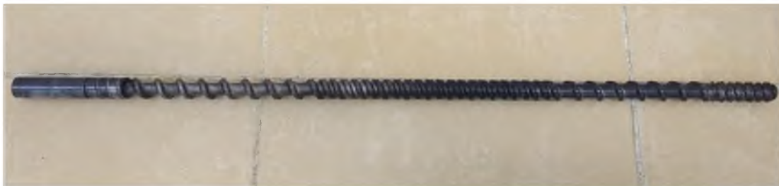
Figura 50.- Husillo implementado para extrusión de materiales compuestos UNPA (campus Tuxtepec). Fuente propia.
