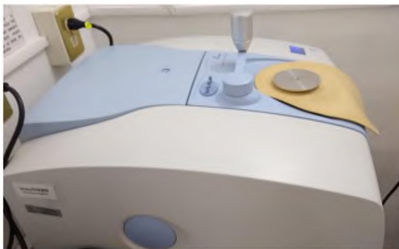
Figura 41.- Espectrómetro FT-IR marca PerkinElmer modelo Spectrum 100 con accesorio de muestreo ATR universal. Fuente propia.
