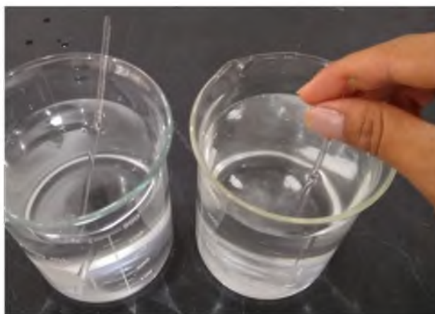
Figura 20.- Homogeneización de la solución de agua destilada - NaOH. Fuente propia.
