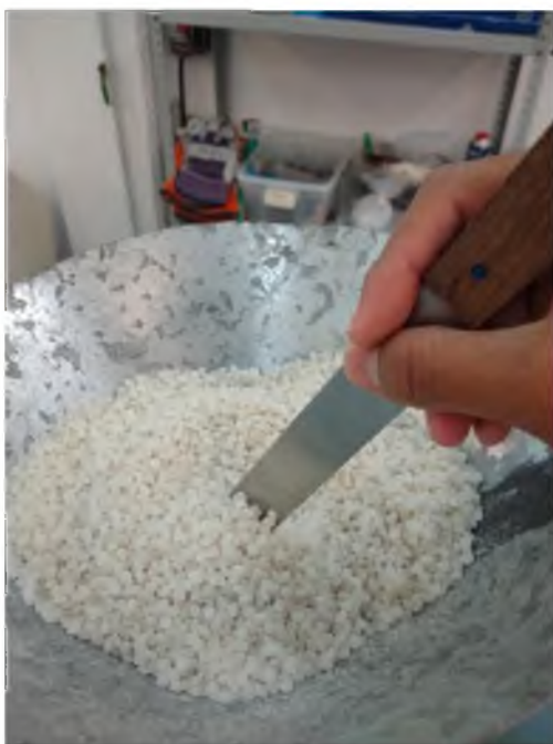
Figura 52.- Vaciado de mezcla PP + Partículas de fibra, para primer ciclo de extrusión. Fuente propia.
