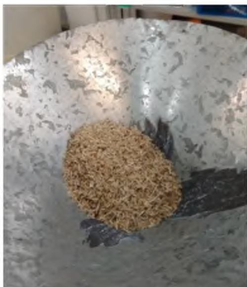
Figura 54.- Alimentación con pellets de material compuesto para segundo ciclo de extrusión. Fuente propia.
