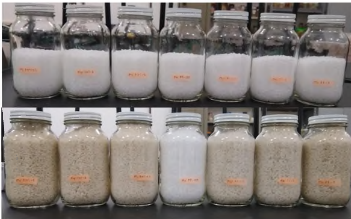
Figura 48.- Mezclas de polipropileno - partículas de fibra en diferentes concentraciones. Fuente propia.
