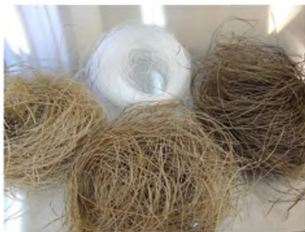
Figura 55.- Filamentos finales con segundo ciclo de extrusión, listos para proceso de peletizado. Fuente propia.
