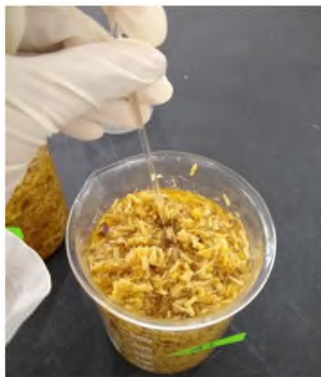
Figura 22.- Removido de fibras sumergidas en solución de NaOH. Fuente propia.
