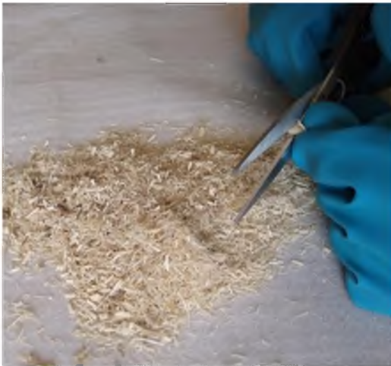
Figura 14.- Proceso de corte manual de las fibras con tijeras. Fuente propia.
