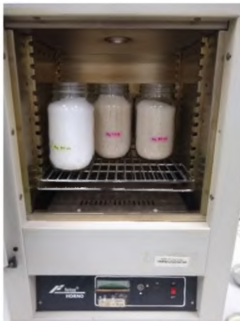
Figura 56.- Secado de muestras de mezcla PP + Partículas de fibra. Fuente propia.
