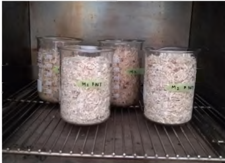
Figura 29.- Ingreso de muestras de F.T y F.N.T para su secado en horno de convección. Fuente propia.
