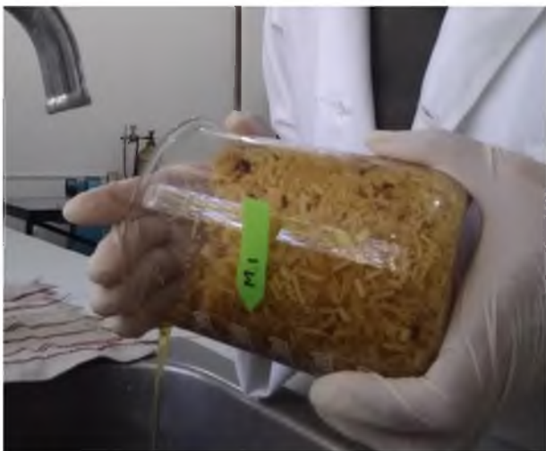
Figura 23.- Primer escurrimiento de las fibras. Fuente propia.
