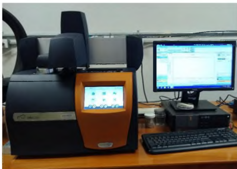
Figura 61.- Calorímetro diferencial de barrido TA-modelo 250. Fuente propia.
