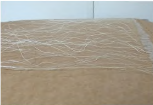
Figura 12.- Muestra de 100 fibras colocadas para ser estiradas y medidas una por una. Fuente propia.
