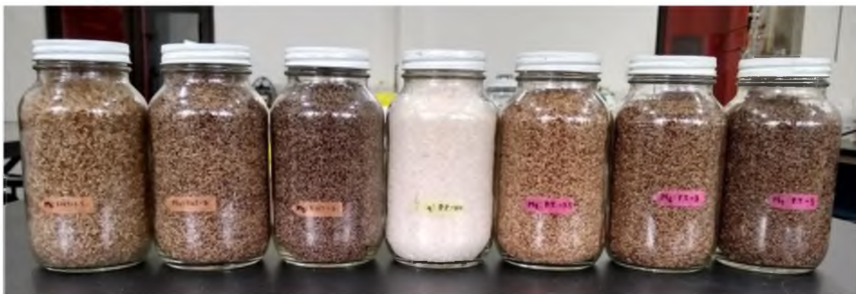
Figura 73.- Pellets de material compuesto de las siete concentraciones sometidas al proceso de extrusión y peletización. Fuente propia.
