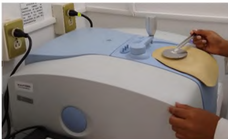
Figura 42.- Muestra de partículas colocadas en el porta muestra del espectrómetro. Fuente propia.
