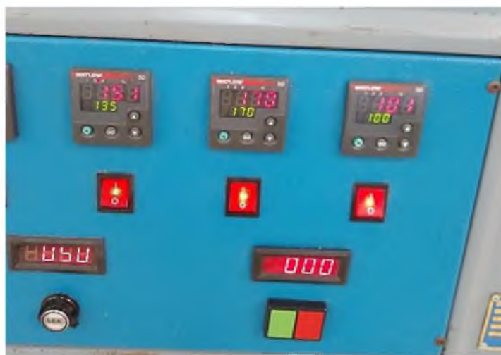
Figura 51.- Condiciones utilizadas para la extrusión del filamento final. Fuente propia.
