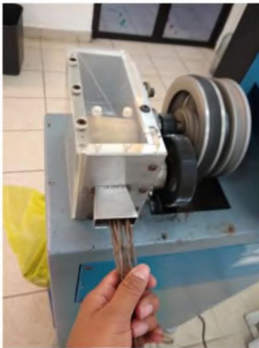
Figura 57.- Filamentos de material compuesto en proceso de peletización. Fuente propia..
