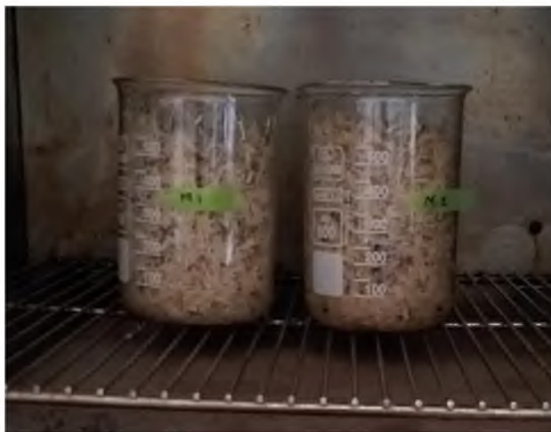
Figura 28.- Ingreso de muestras de fibras tratadas para su secado en horno de convección marca Fisher Scientific. Fuente propia.
