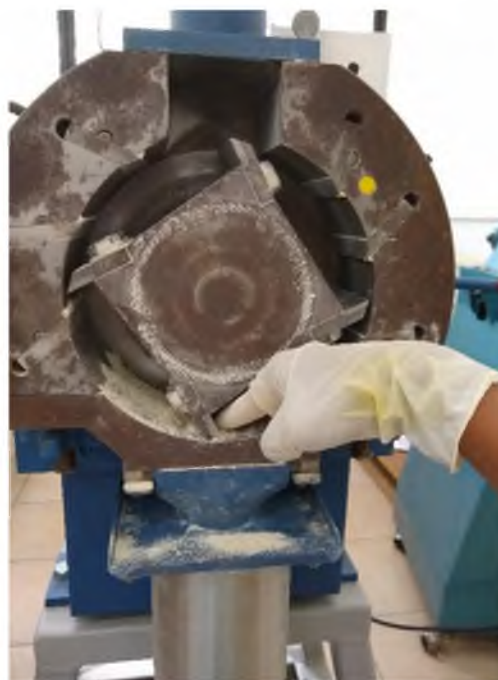
Figura 33.- Limpieza y extracción de fibra restante. Fuente propia.
