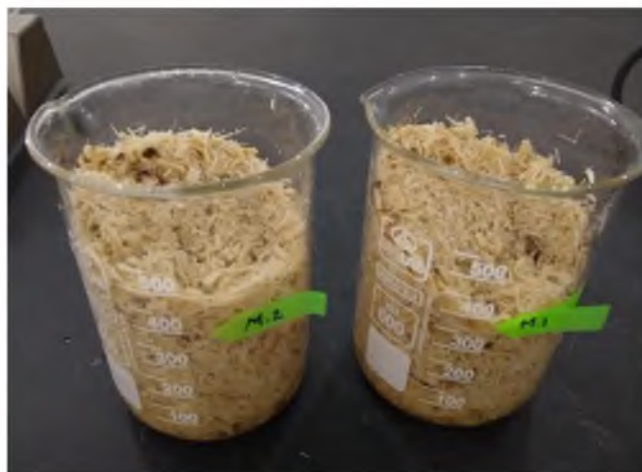
Figura 27.- Fibras escurridas listas para el proceso de secado. Fuente propia.
