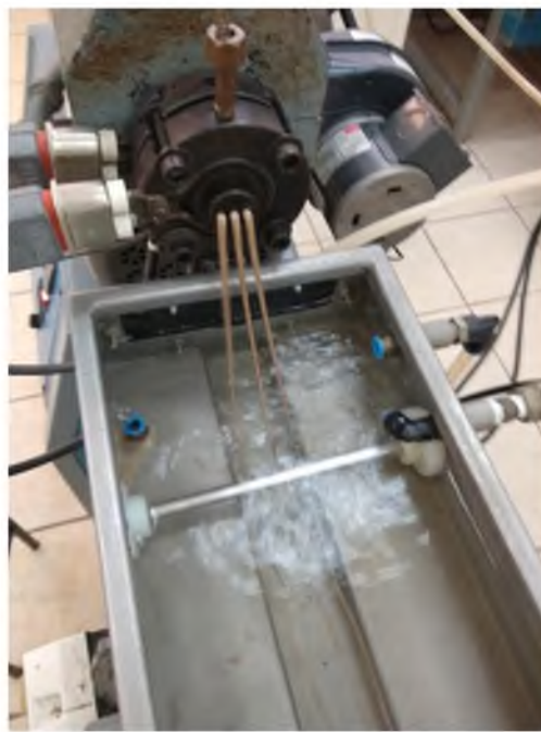
Figura 53.- Filamento extruído en sistema de enfriamiento. Fuente propia.
