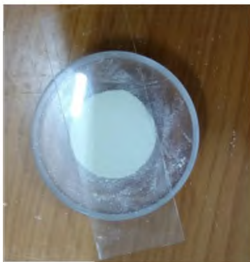
Figura 39.- Muestra compactada con ayuda de un porta objetos. Fuente propia.
