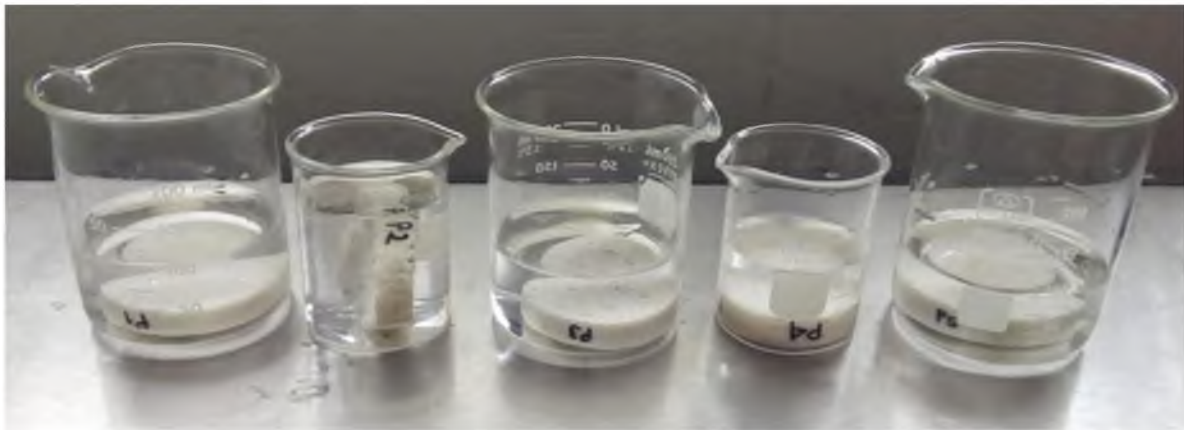
Figura 24. Cinco muestras en agua por 24 horas.
