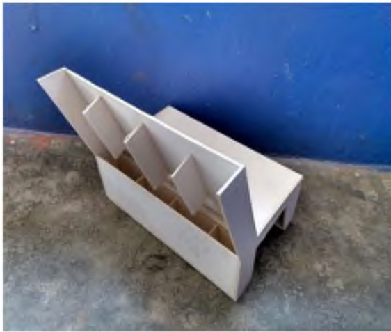
Figura 40. Banca pegada con pegamento blanco y con refuerzos.
