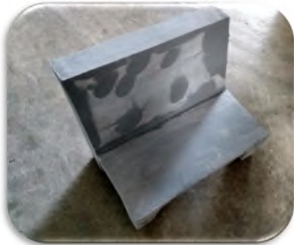
Figura 48. Aplicación de plaster y lijada de plaster parte frontal
