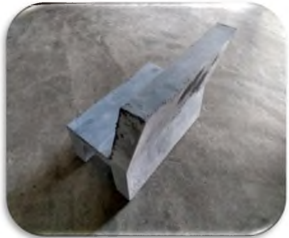
Figura 44. Aplicación de plaster parte posterior
