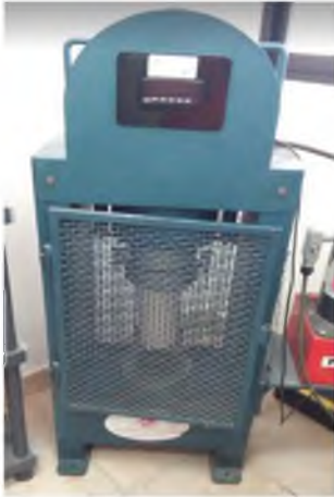
Figura 18. Prensa eléctrica marca DAVISA con una capacidad de 120 toneladas
