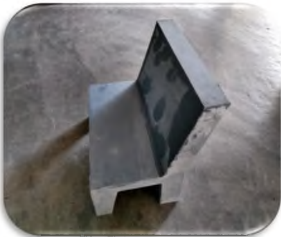
Figura 45. Aplicación de plaster y lijada de plaste parte lateral y frontal.
