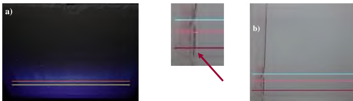
Figura 25. a) CP revelada bajo radiación UV-365 nm. b) CP revelada con ninhidrina, \Delta .
