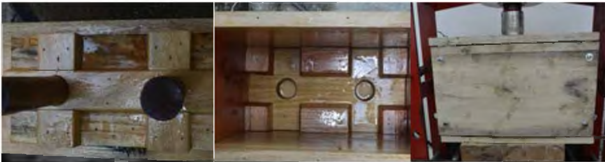
A) Aplicación de desmoldante B) Aplicación de desmoldante C) Molde sometido a prensado Figura 37. Proceso de moldeado y prensado
