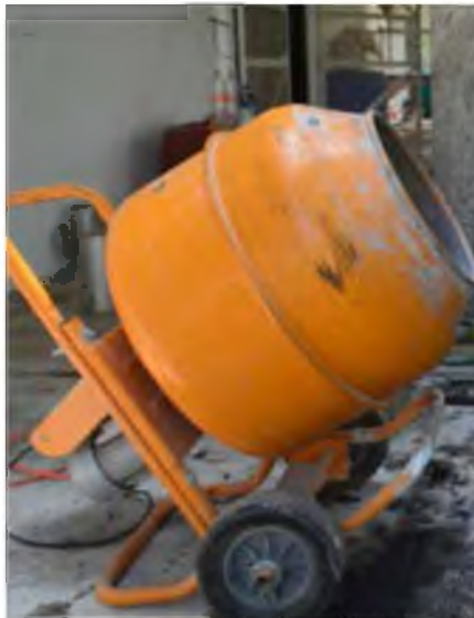
Figura 11. Mezclador eléctrico de 50 kg
