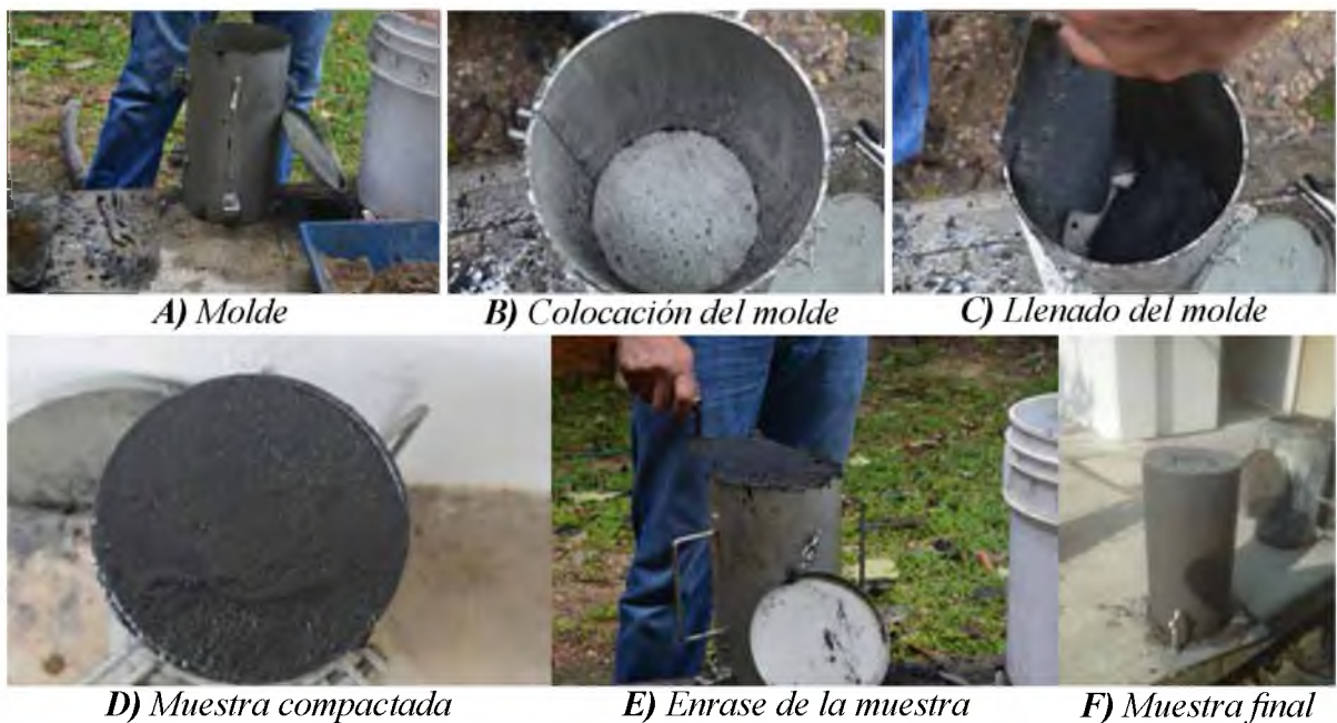
Figura 12. Proceso del colado de probetas de ensayo en laboratorio
