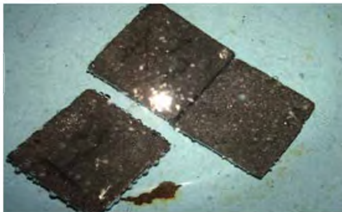
Figura 8. Especímenes en proceso de curado
