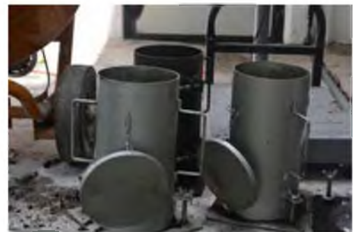
Figura 10. Moldes para las probetas de 15 cm de ancho* 30 cm alto.
