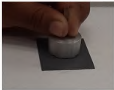
(b) Pulido de fibra con lija de grano 600
