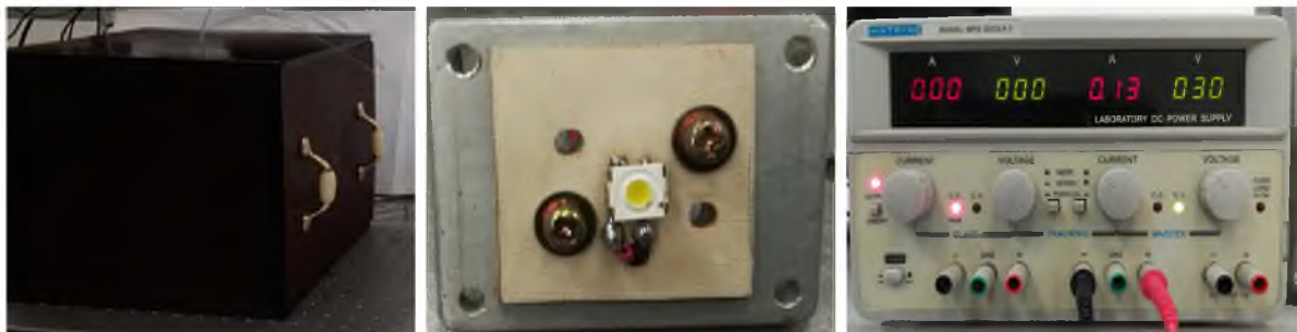
(a) Caja negra de dimensión 30\text{cm} \times 30\text{cm} \times 30\text{cm} para el sistema de medición. (b) LED de color blanco OPTEK TECHNOLOGY modelo 3003LK-3 . (c) Fuente de voltaje directa Matrix OVSPW1BCR4 de 1\text{Watt} de potencia, 350\text{mA} , 3.5\text{V} .
