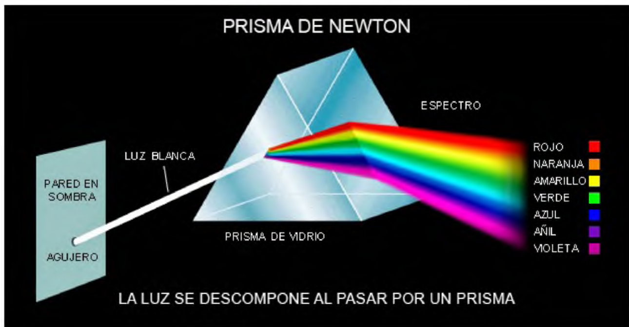
Figura 2.1: Dispersión de la luz blanca al pasar por un prisma.
