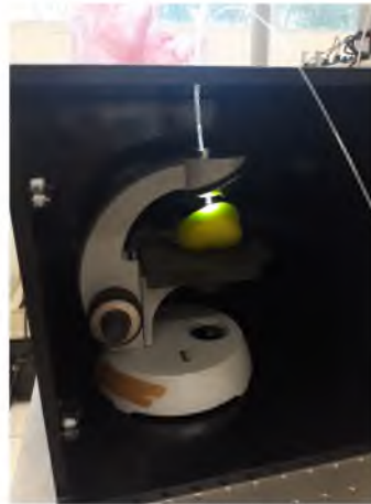
Figura 5.9: Incidencia de luz sobre la muestra y fibra óptica de 1\text{mm} recibiendo la luz reflejada por la muestra.
