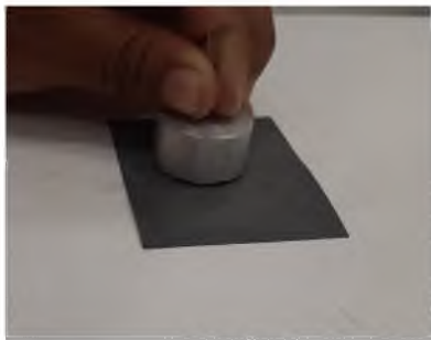
(a) Pulido de fibra con lija de grano 500
