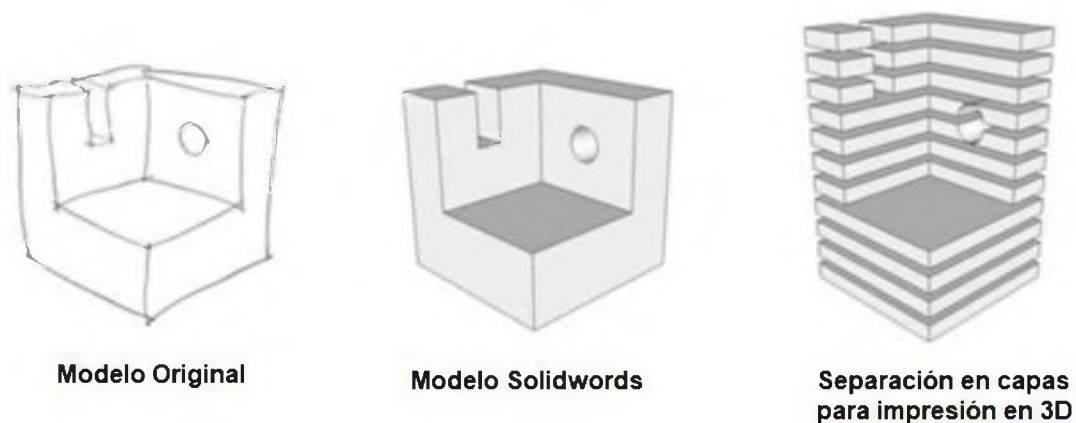
Figura 35. Proceso de diseño de una pieza con una impresora 3d.
