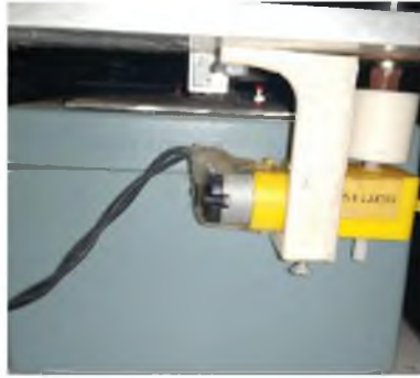
Figura 45. Base del motorreductor.
