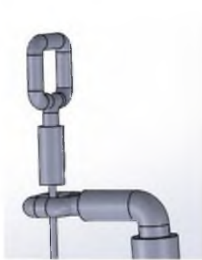
Figura 33. Sostén de biela (sistema de guiado).
