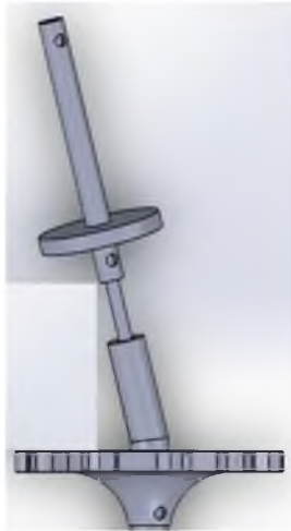
Figura 34. Engrane unido a un soporte angular.
