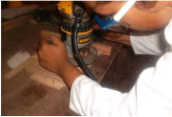
Figura 27: Colocación del Router
