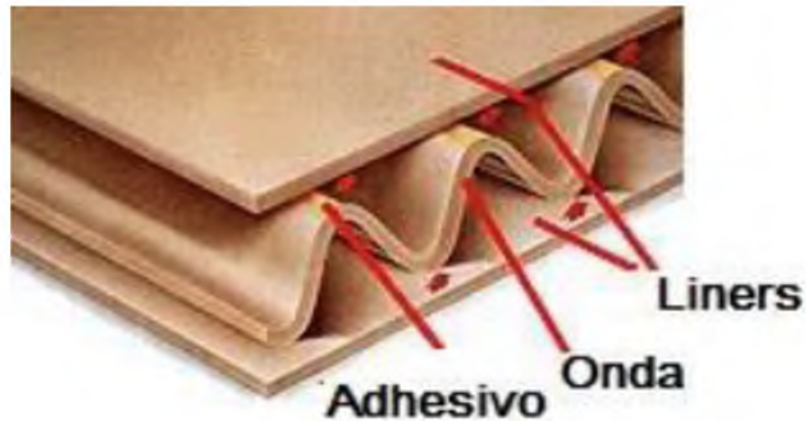
Figura 4: Estructura del cartón corrugado
