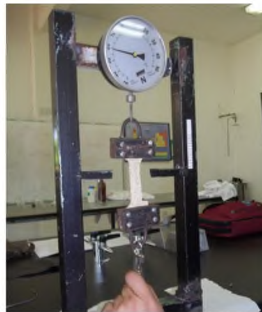
Figura 49: Tensión de la probeta
