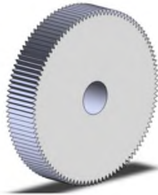
Figura 3.23 Engrane para el eje de los motorreductores.
