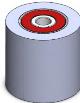
Figura 3.4 Rodamiento 6302-2RS montado sobre la base.
